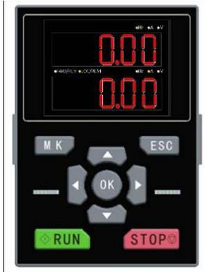
SID\_LED\_OP внешняя выносная LED панель оператора с двустрочным цифровым дисплеем. Имеет возможность сохранения и переноса одного набора параметров. Подключается с помощью обычного сетевого кабеля к разъёму RJ45 преобразователя
