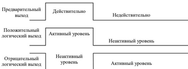
Рисунок 7-14 Диаграмма положительной и отрицательной логики цифрового выхода
