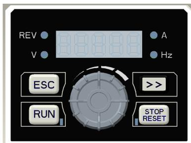
Рисунок 4-1 Светодиодная клавиатура
