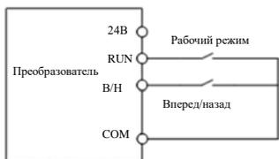
(a) Схема подключения двухпроводного управления (F00.03=0)
