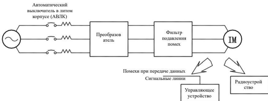
Рисунок 3-7 Установка фильтра подавления помех на выходной стороне
