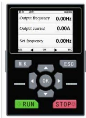
SID\_LCD\_OP внешняя выносная панель оператора на с графическим ЖК экраном на русском языке. Имеет возможность сохранения и переноса одного набора параметров. Подключается с помощью обычного сетевого кабеля к разъёму RJ45 преобразователя.
