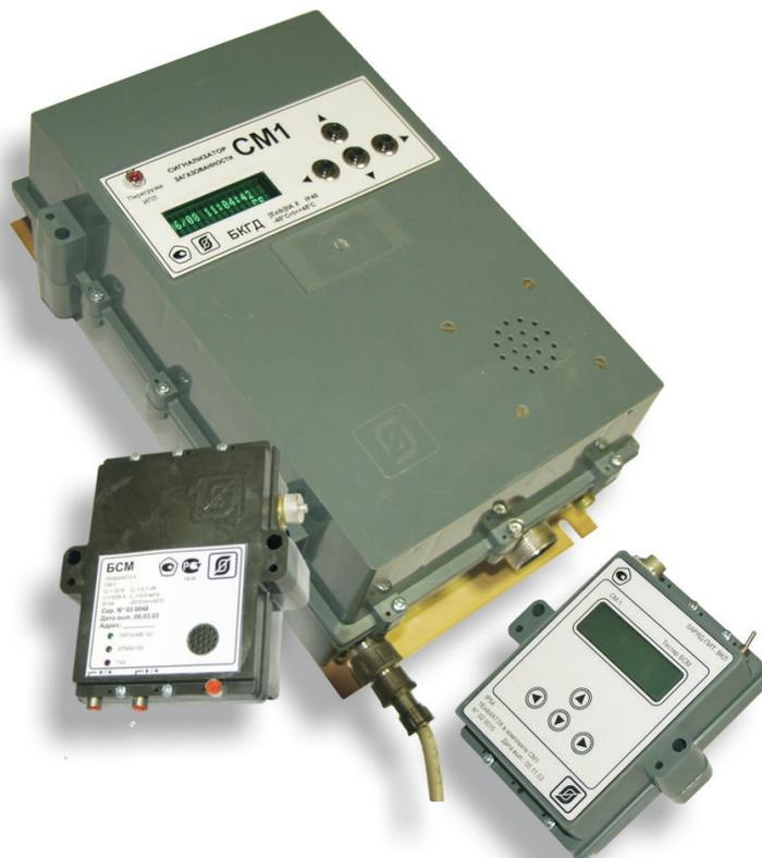
Автоматический термохимический взрывозащищенный сигнализатор загазованности СМ-1 является средством измерения и предназначен для контроля дозрывоопасных концентраций горючих газов, паров и их смесей в воздухе. СМ-1 обеспечивает выдачу местной световой и звуковой сигнализации, передачу информации о превышении установленного значения концентрации горючих газов в воздухе внешним устройствам по линии информационной связи RS-232.
