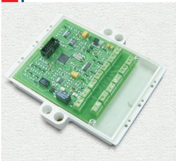
Канал передачи информации на основе интерфейсов RS-232, RS-485, Токовая петля.
