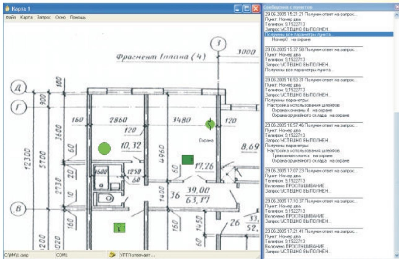
В состав системы М4 входит программа Сатурн-М4 предназначенная для сбора информации с удаленных пунктов от установленных на них контроллеров КМ, отображения состояния контролируемых шлейфов сигнализации и тревожных срабатываний охранных или пожарных извещателей, удаленного конфигурирования КМ, настройки параметров программы.
