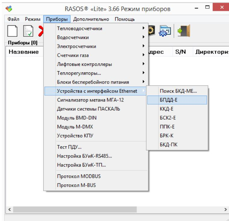
Важно, чтобы в настройках сетевого подключения IP адрес компьютера принадлежал той же сети, что и блок БПДД-Е. Например, если адрес БПДД-Е 192.168.1.240, то IP адрес компьютера должен быть хотя бы 192.168.1.1, маска подсети 255.255.255.0.
