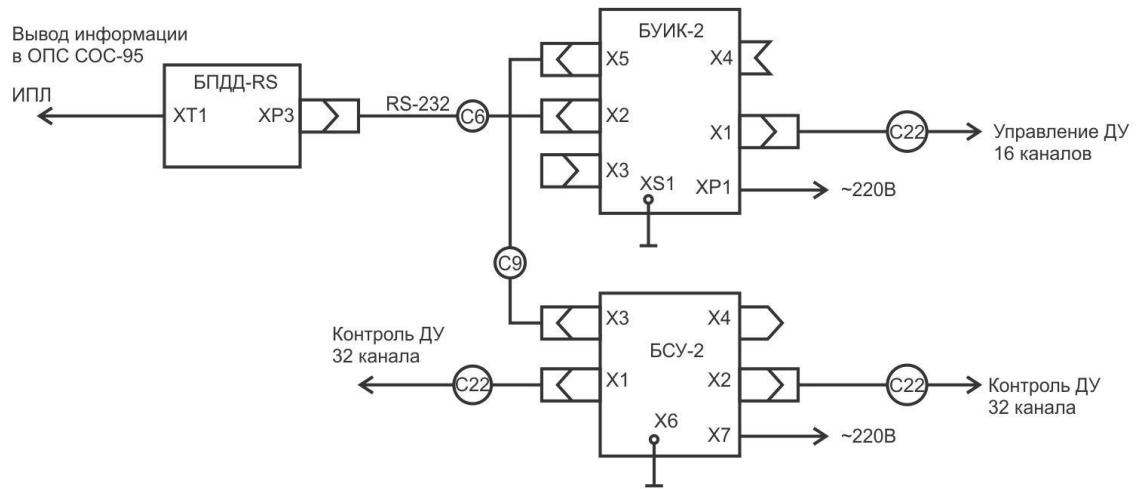
Для локальных систем СДУ блоки БУИК-2 могут быть объединены по интерфейсу RS-485 в количестве до 16 шт. Длина линии интерфейса RS-485 может достигать 1,2 км.
