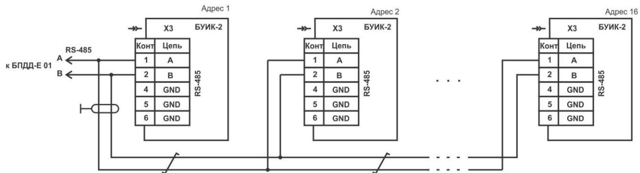
В блоках, подсоединенных к концам линии интерфейса RS-485, необходимо установить перемычку на платах БУИК-213 для подключения оконечных согласующих резисторов.
