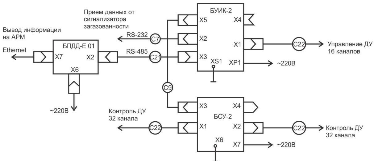
Подключить БПДД-Е 01 к свободному порту коммутатора локальной сети Ethernet. К другому свободному порту подключить персональный компьютер с установленной программой RASOS. Подать напряжение питания на БСУ-2, БУИК-2 и БПДД-Е 01. Включить компьютер и запустить программу RASOS.
