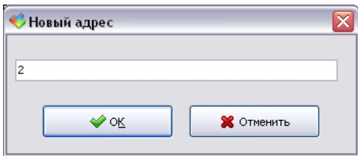
При объединении БУИК-2 по интерфейсу RS-485 (до 16 шт.) следует устанавливать блокам индивидуальные адреса.
