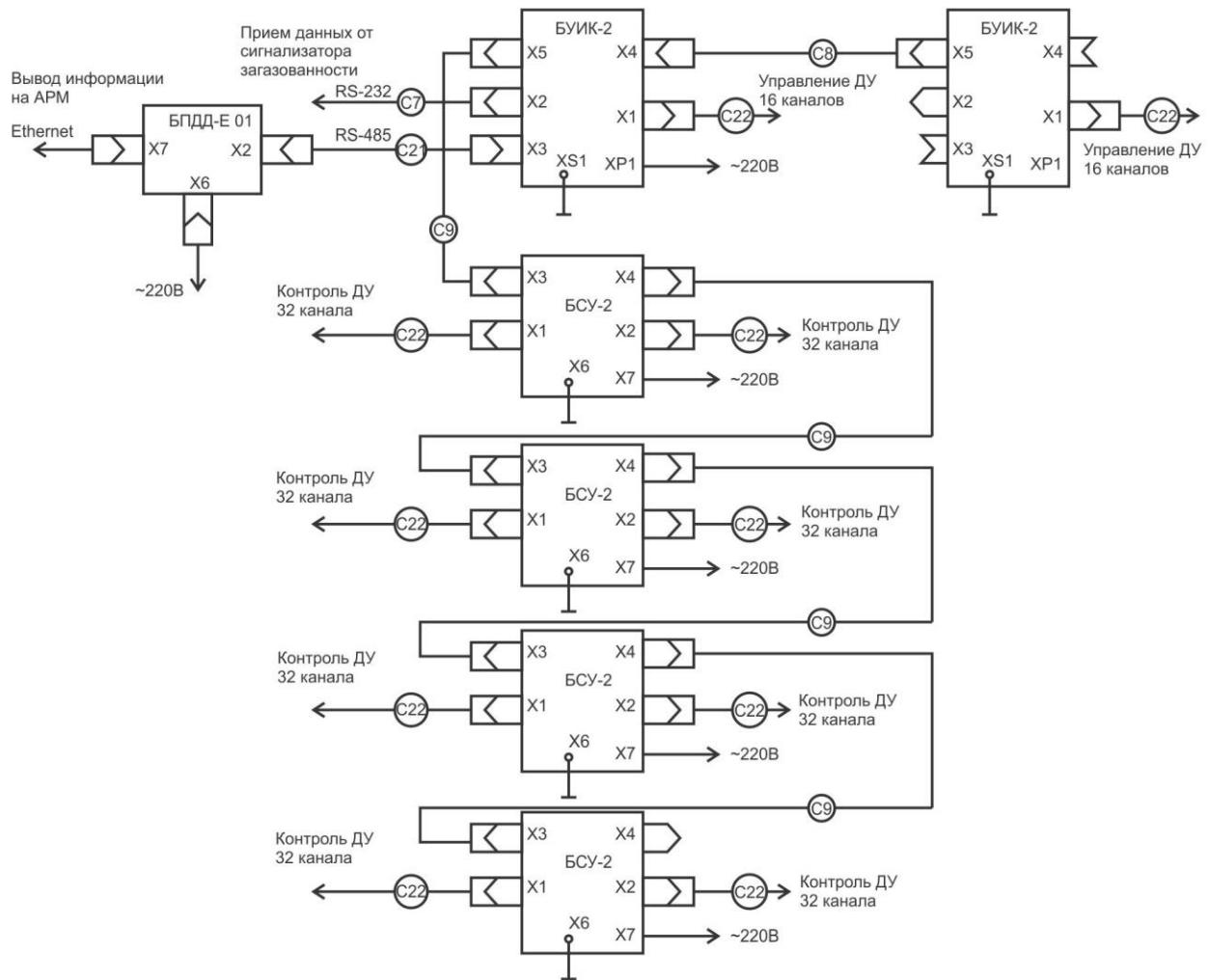
Конфигурация блоков СДУ при выводе информации через ОПС «СОС-95» состоит из блоков БСУ-2 БУИК-2, БПДД-RS. Возможно каскадирование БСУ-2 и БУИК-2 как в максимальной конфигурации, показанной выше. Количество каналов контроля в этом случае будет 256 шт., количество каналов управления – 32 шт.
