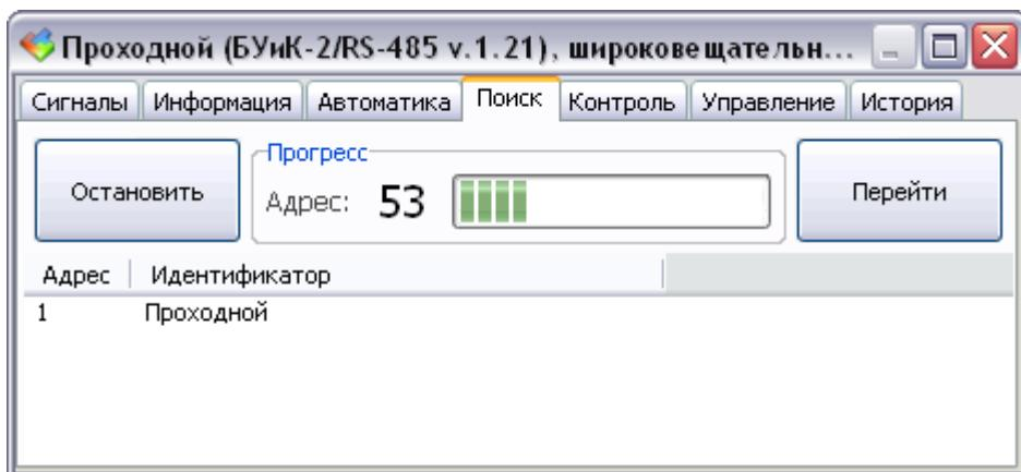
Нажать на кнопку «Поиск». Найденные блоки, их адреса и текстовые идентификаторы будут отображаться в таблице. Чтобы перейти к параметрам выбранного блока надо его выделить в таблице и нажать на кнопку «Перейти». Откроется вкладка «Информация» требуемого блока.
