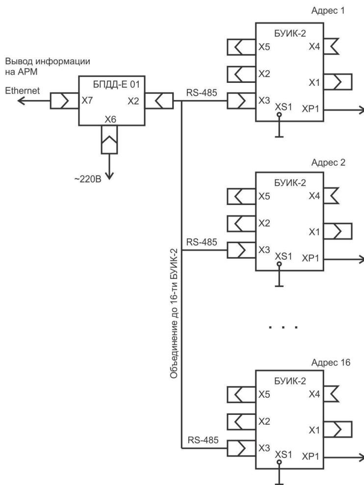
Для больших и территориально распределенных систем СДУ возможно объединение на основе локальной вычислительной сети Ethernet, используя сетевые маршрутизаторы и блоки БПДД-Е 01.
