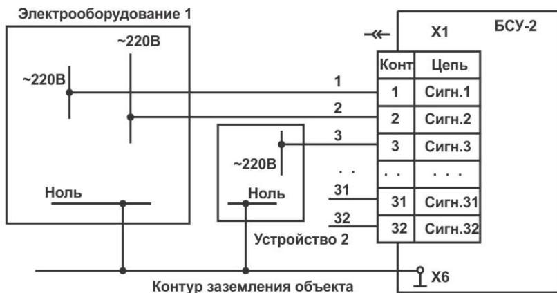
Цепи управления нагрузкой (фидера групп освещения, насосов, вентиляторов и проч.) подключается к разъему X1 блока БУИК-2 при помощи соединителя С22. Как правило, для подключения этих цепей используется клеммно-соединительные коробки (КСК). Типовая схема подключения каналов управления диспетчеризируемого электрооборудования показана на рисунке ниже.
