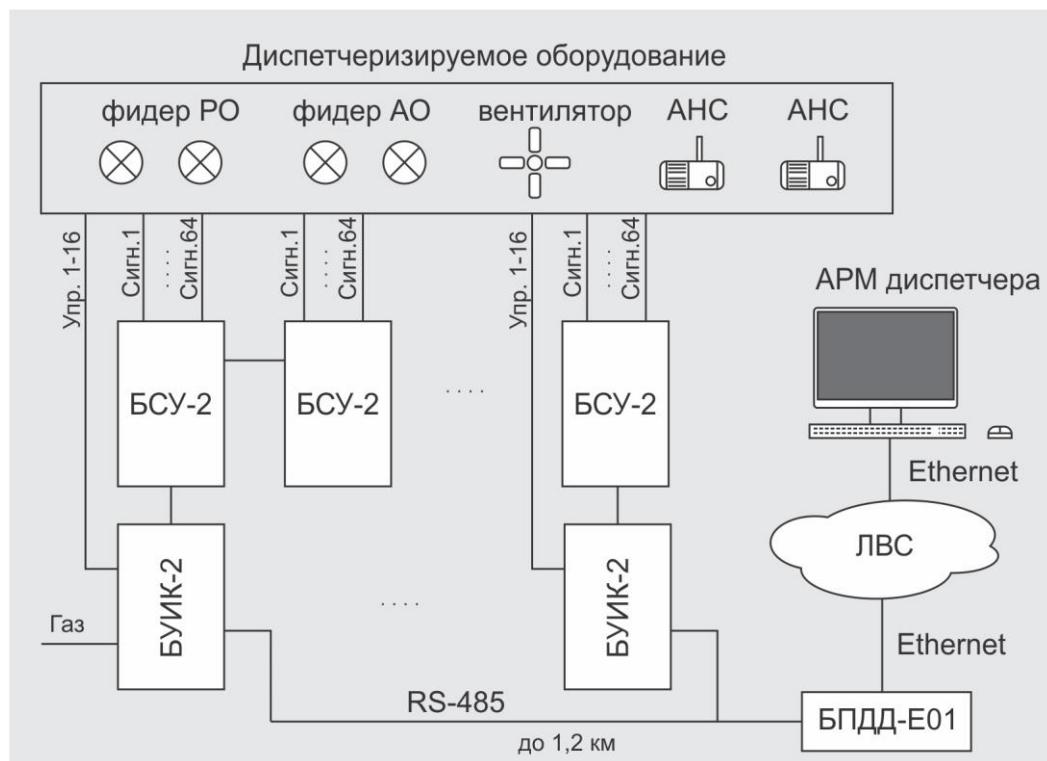
Система диспетчерского управления СДУ «Сатурн» состоит из следующих элементов:
