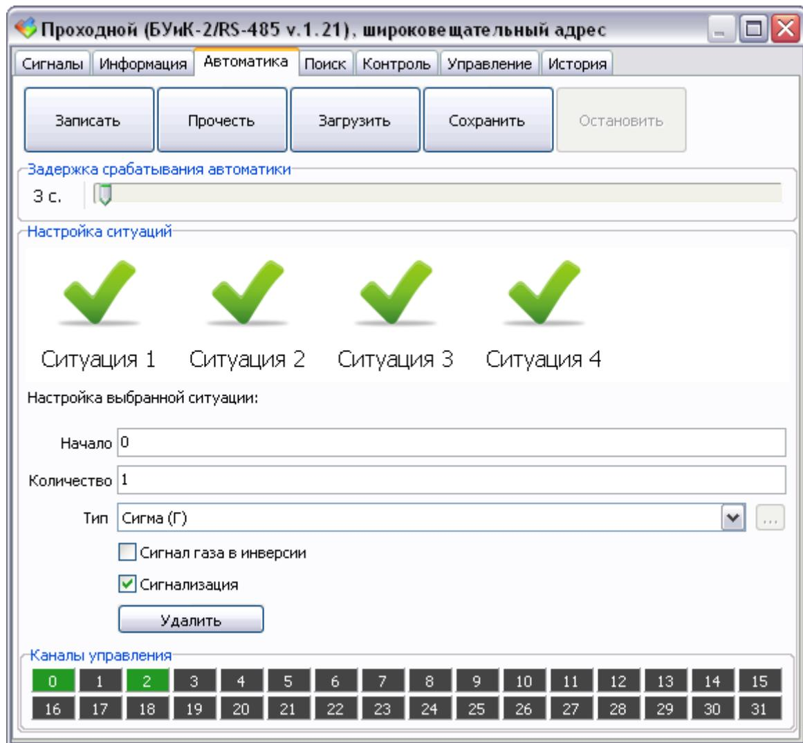
Для настройки первой ситуации выбрать «Ситуация 1». Задать время задержки срабатывания автоматики переключения каналов управления «Задержка срабатывания автоматики» в диапазоне (1 – 255) сек от момента поступления сигнала о загазованности. Не рекомендуется устанавливать время задержки менее 5 секунд. Время задержки устанавливается для всех четырех газовых ситуаций одновременно.
