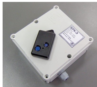
Рисунок 4 - Радиоконцентратор и радиоидентификатор электрооборудования
