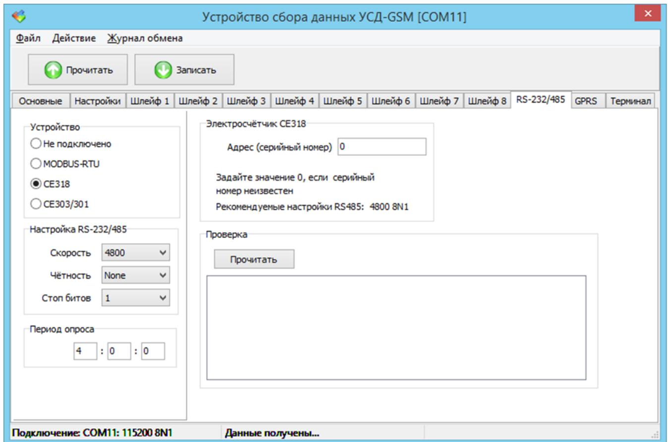
Рисунок 23 – Вкладка «RS-232/485» в режиме настройки для CE318
