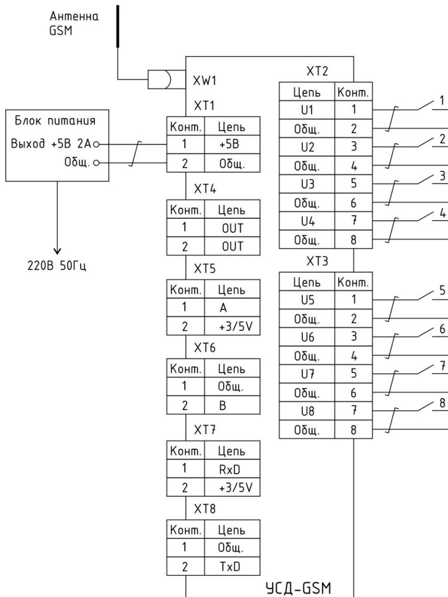
Рисунок 5 - Схема электрическая типового подключения устройства УСД-GSM
