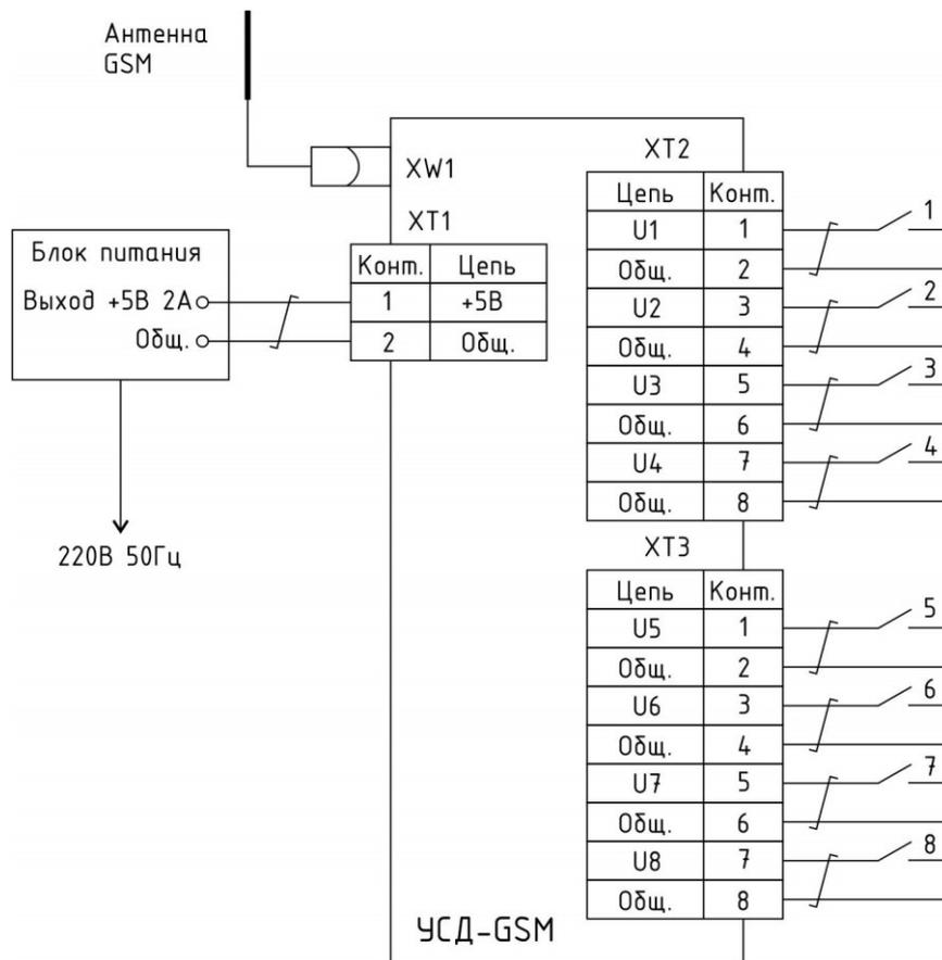
Рисунок 31 - Схема подключения датчиков с выходами «сухой контакт» и внешнего блока питания
