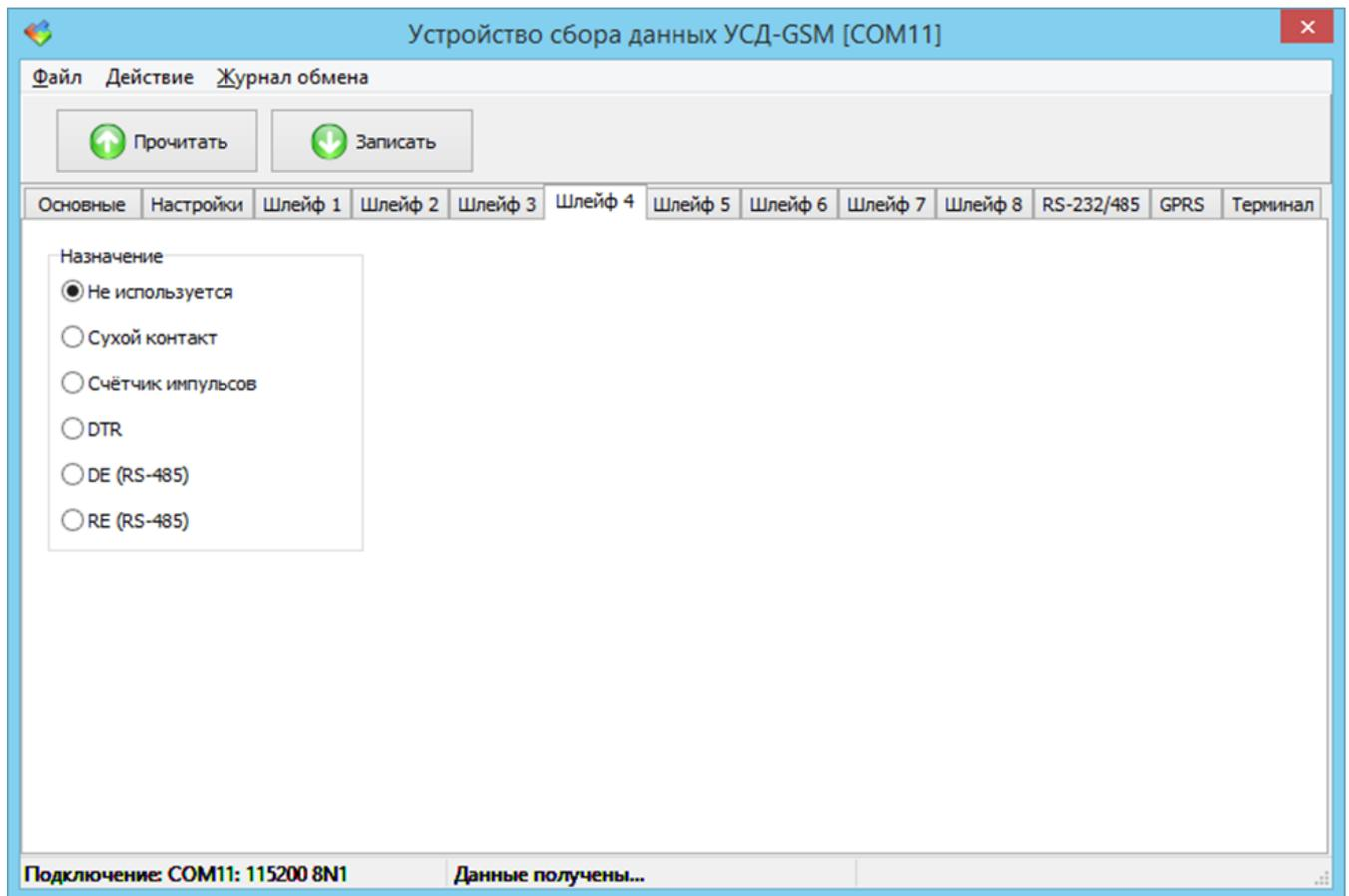
Рисунок 15 – Вкладка настройки шлейфа 4 окна конфигурации УСД-GSM
