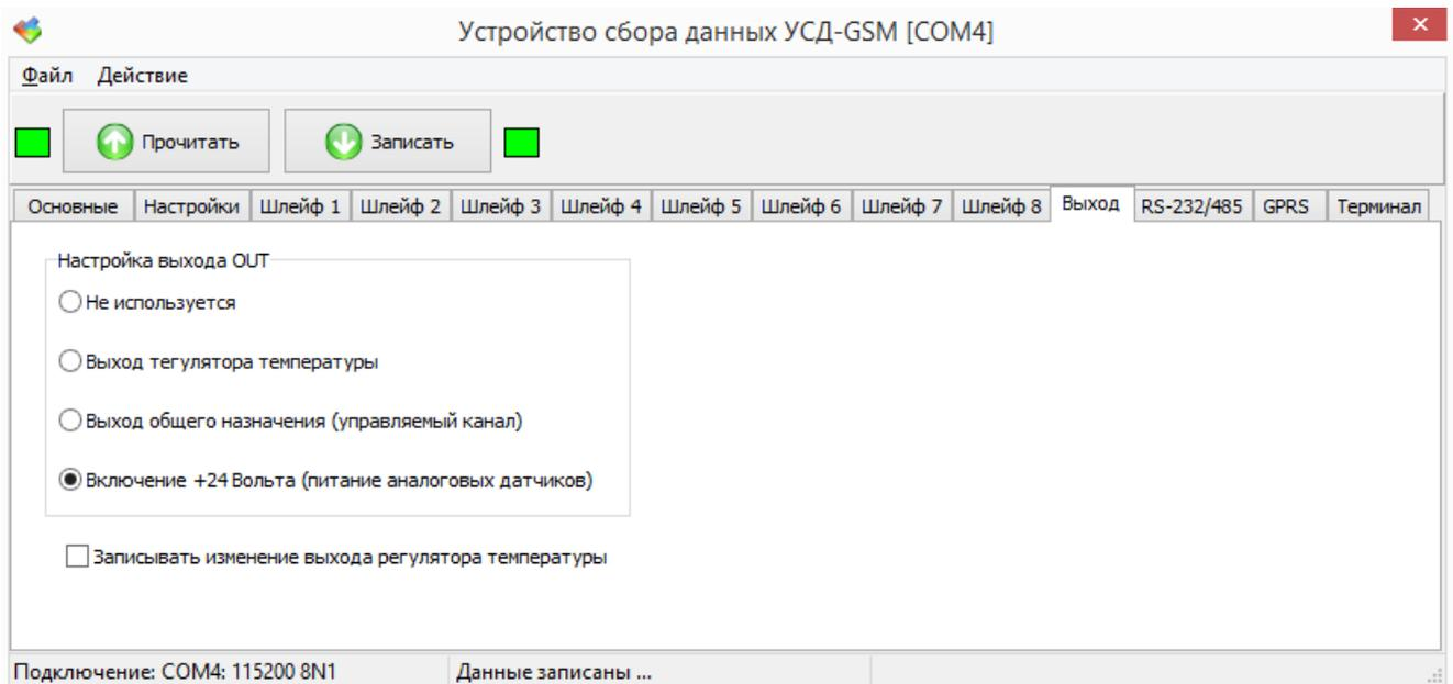
Рисунок 20 – Вкладка настройки выхода OUT конфигурации УСД-GSM
