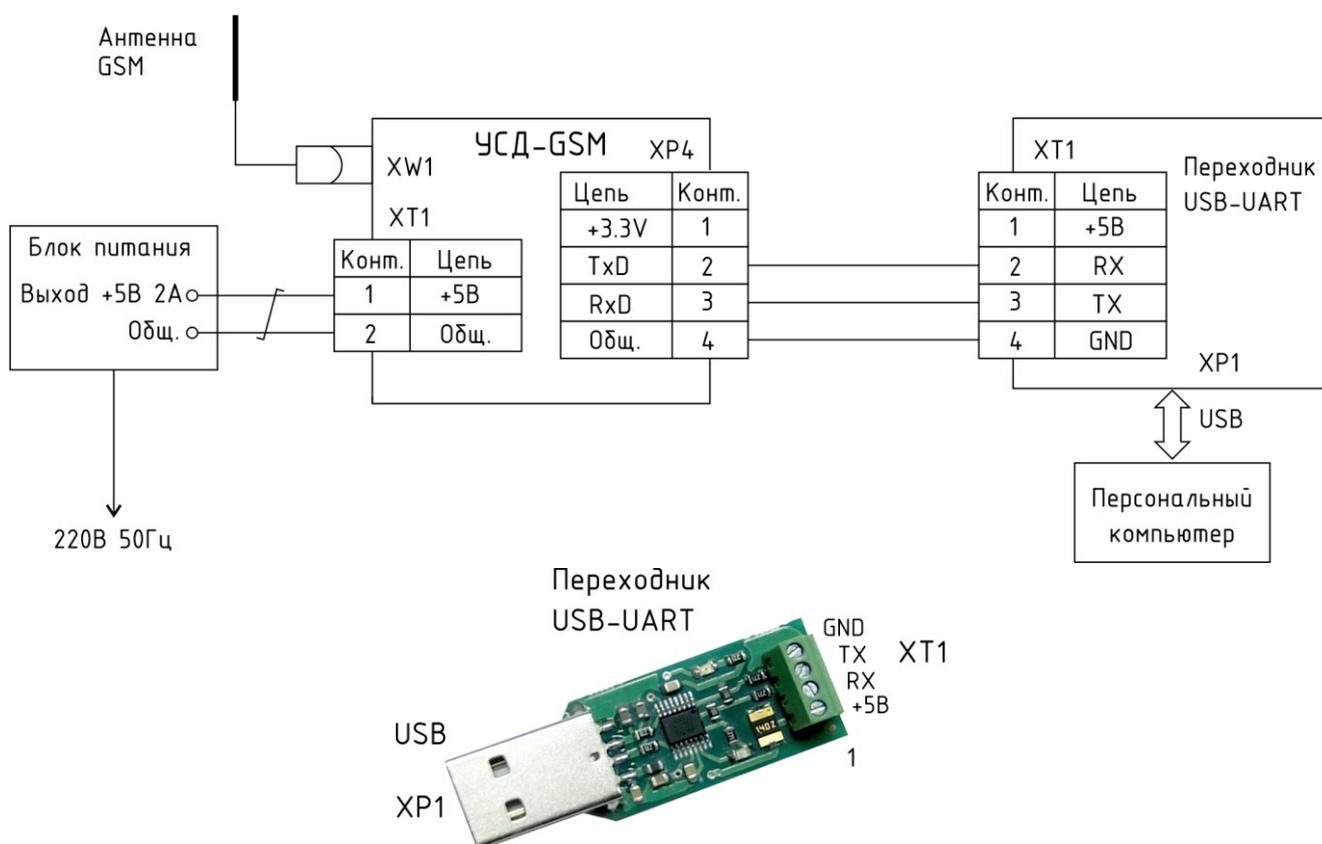
Рисунок 6 - Подключение УСД-GSM к переходнику USB-UART
