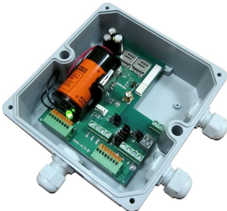
Рисунок 3 - Вид на электронную плату устройства со снятой крышкой корпуса
