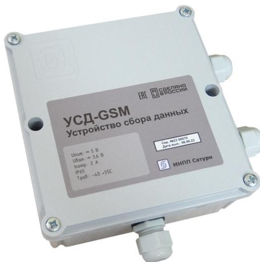
Рисунок 1 - Внешний вид устройства сбора данных УСД-GSM
