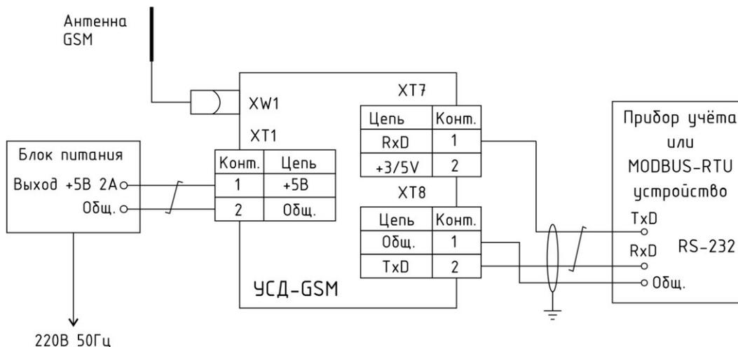
Рисунок 43 - Схема подключения внешнего устройства по интерфейсу RS-232
