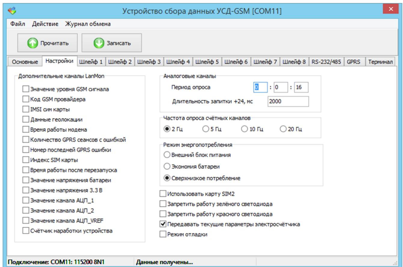
Рисунок 10 – Вкладка «Настройки» окна конфигурации УСД-GSM
