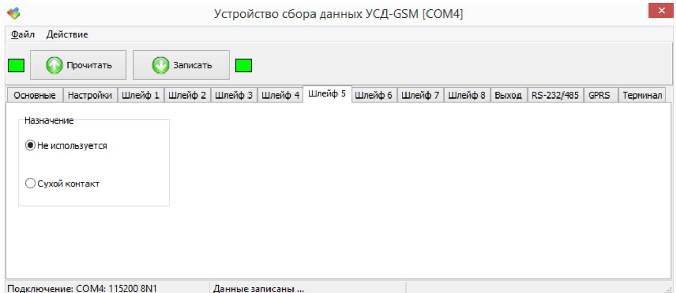
Рисунок 16 – Вкладка настройки шлейфа 5 окна конфигурации УСД-GSM
