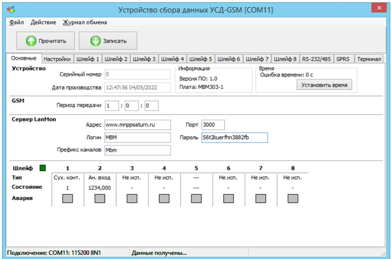
Рисунок 9 – Вкладка «Основные» окна конфигурации УСД-GSM
