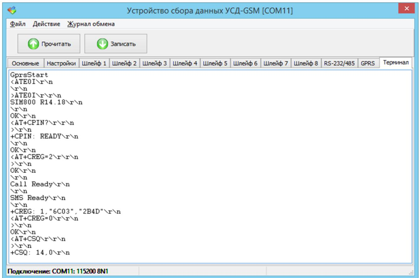
Рисунок 48 – Вкладка «Терминал» окна конфигурации УСД-GSM
