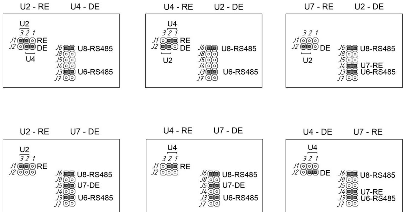
Рисунок 41– Примеры установки перемычек J1-J8 в зависимости от используемых сигналов U2, U4, U7 для интерфейса RS-485
