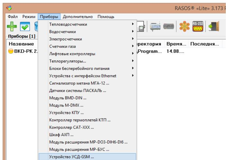
Рисунок 7 – Вызов окна конфигурации УСД-GSM
