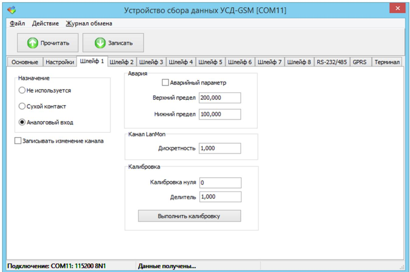
Рисунок 12 – Вкладка настройки шлейфа 1 в качестве аналогового входа
