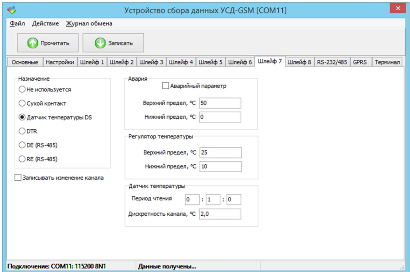
Рисунок 18 – Вкладка настройки шлейфа 7 окна конфигурации УСД-GSM
