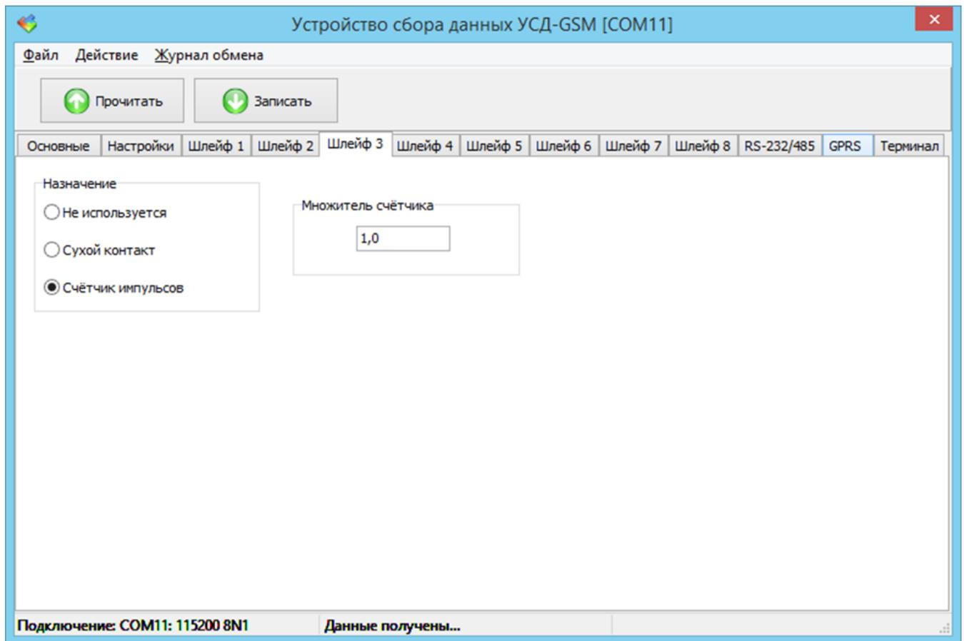
Рисунок 14 – Вкладка настройки шлейфа 3 окна конфигурации УСД-GSM
