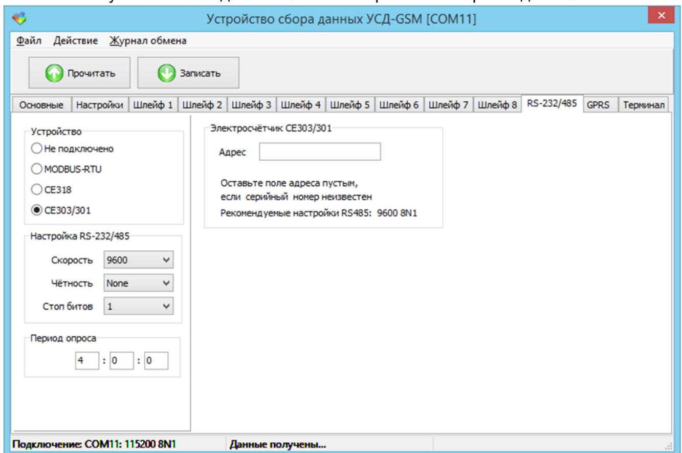
Рисунок 24 – Вкладка «RS-232/485» в режиме настройки для CE303/301
