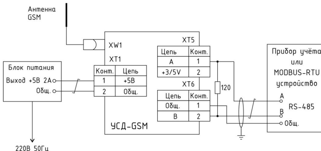
Рисунок 39 - Схема подключения внешнего устройства по интерфейсу RS-485
