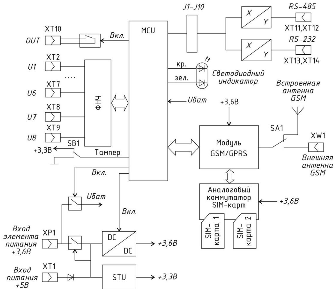
Рисунок 5 – Функциональная схема устройства УСД-GSM
