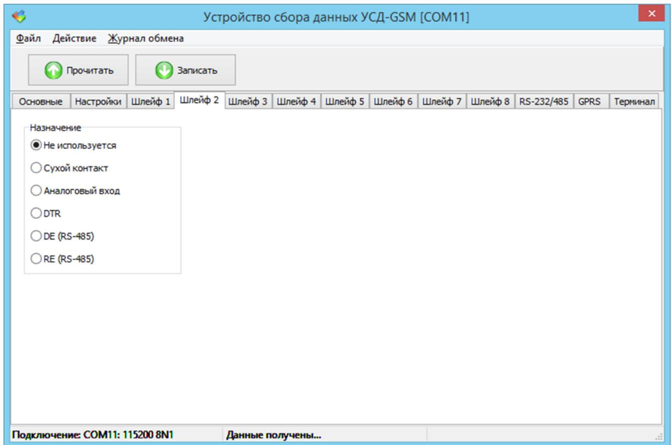
Рисунок 13 – Вкладка настройки шлейфа 2 окна конфигурации УСД-GSM
