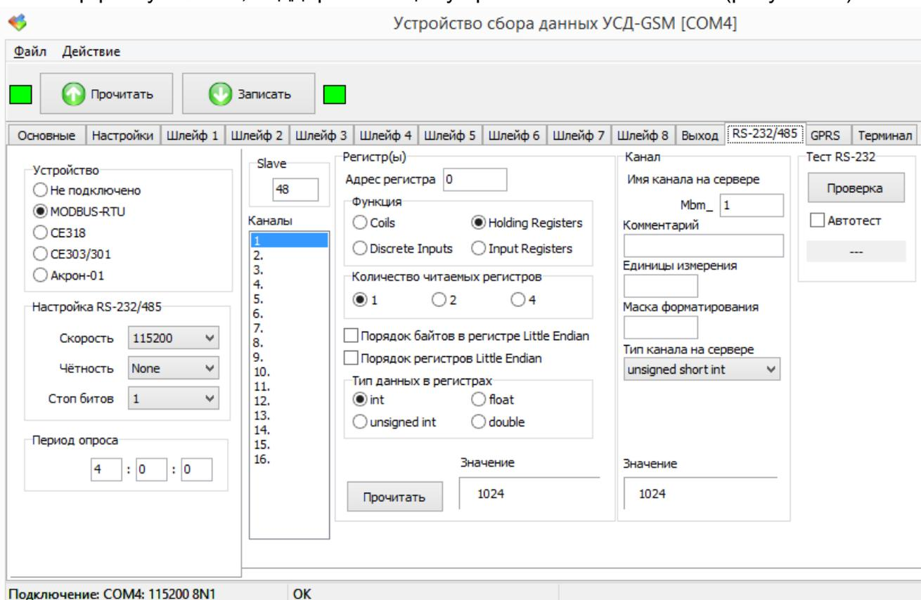
Рисунок 46 – Пример проверки считывания регистров MODBUS RTU
