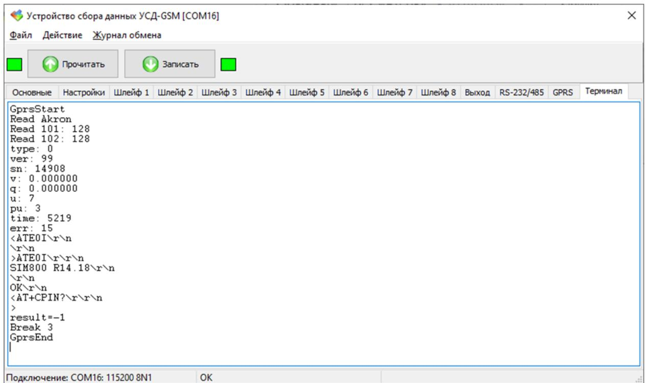
Рисунок 30 – Данные «Акрон-01», передаваемые на сервер LanMon
