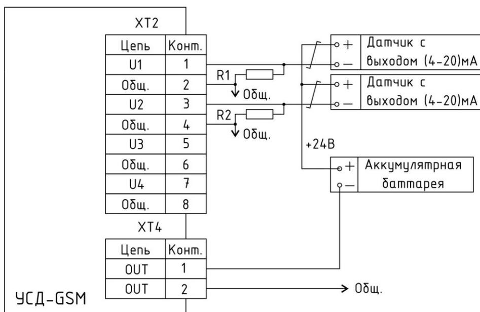
Рисунок 35 - Схема подключения датчиков с аналоговым выходом (4-20) мА для автономного электропитания
