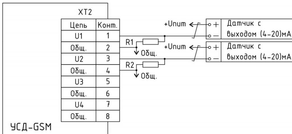
Рисунок 33 - Схема подключения датчиков с аналоговым выходом (4-20) МА
