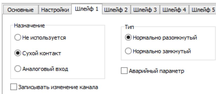
2. Установить переключатель в соответствии с типом «сухого контакта» (нормально разомкнутый или нормально замкнутый).
