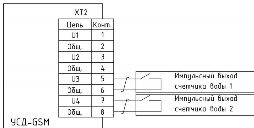
Рисунок 36 - Схема подключения датчиков с выходами «сухой контакт» и внешнего блока питания
