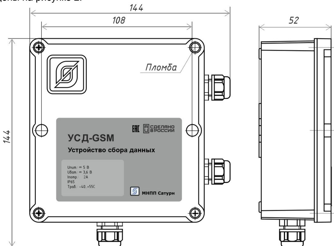
Рисунок 2 - Габаритные размеры устройства сбора данных УСД-GSM
