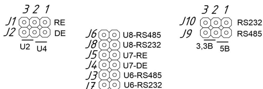
Рисунок 38 – Расположение переключателей J1–J10 на электронной плате
