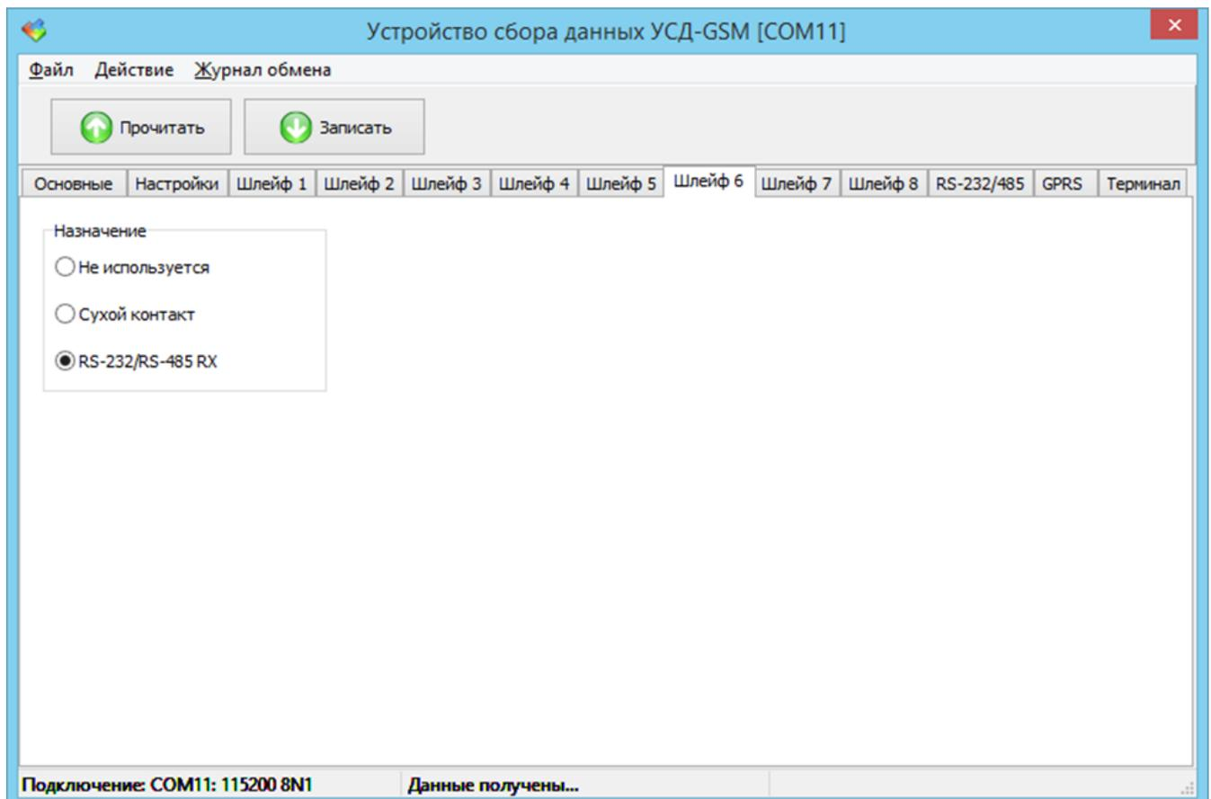
Рисунок 17 – Вкладка настройки шлейфа 6 окна конфигурации УСД-GSM
