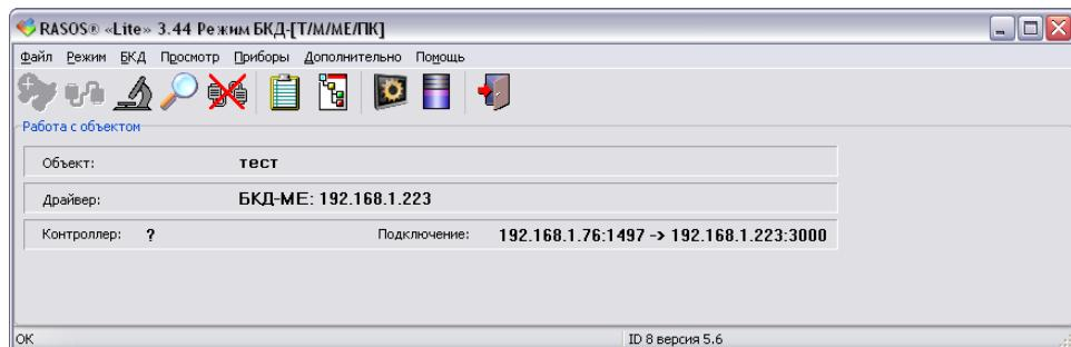
3) Выполнить команду поиска виртуальных адресных устройств. Будут найдены два виртуальных устройства: БКД-М и трансивер радиоканала БРК-Э. Выбрать в таблице найденных устройств БРК-Э и выполнить команду «Тест». Откроется окно с настройками трансивера радиоканала БРК-Э. Выбрать вкладку «Настройка БКД-ПК-RF».
