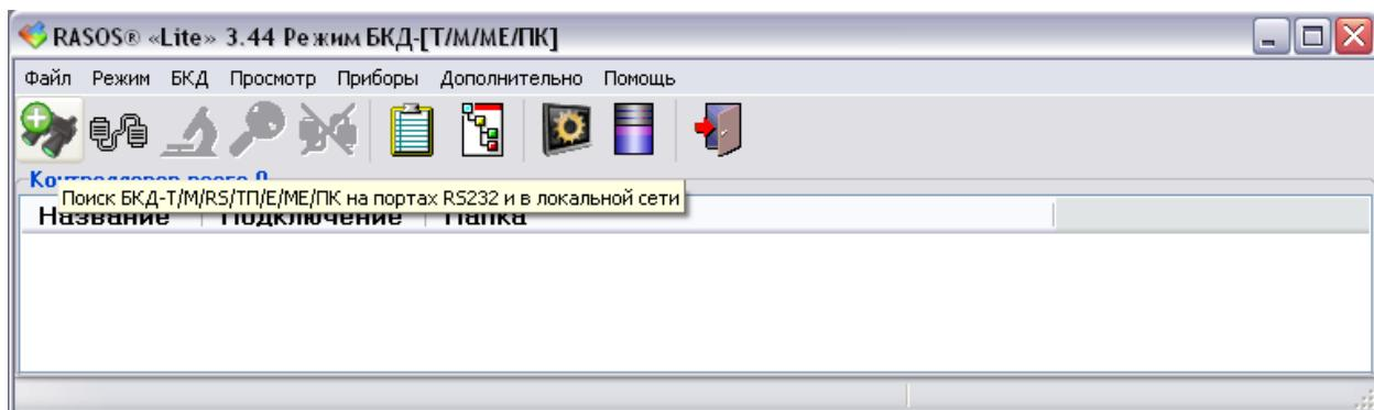
RASOS начнет поиск всех контроллеров, подключенных к интерфейсу Ethernet. Найденный контроллер ECA Connect будет занесен в таблицу. Контроллер отображается в таблице как два устройства - виртуальные контроллеры БКД-МЕ и БКД-ПК.
