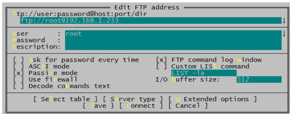
После подключения к контроллеру открыть файл device.ini (расположен в папке config) и добавить следующую запись с указанием номера СОМ-порта, например, PORT="/dev/ttyS0" – БНП подключен к порту ttyS0 разъем X12. Указать скорость обмена с БНП speed=115200 бит/с
