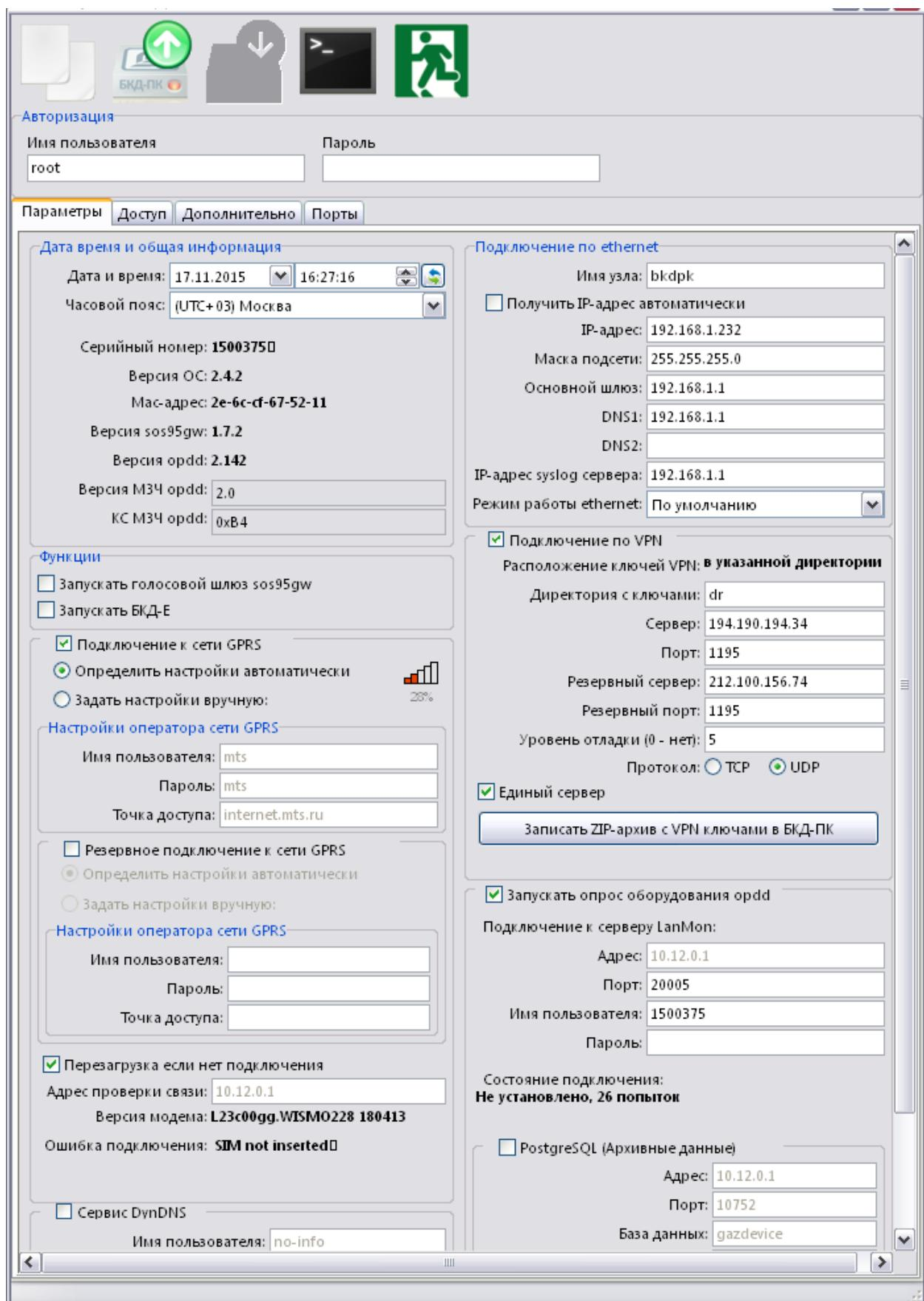
Пример настройки контроллера для проводного Ethernet соединения.
