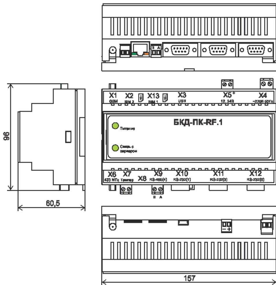
К разъемам X4, X5, X7, X9 подключаются внешние разъемы с клеммниками «под винт».
