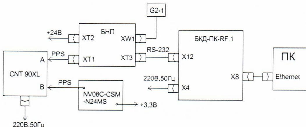
Рисунок 1 – Схема подключения приборов и устройств для поверки контроллера
