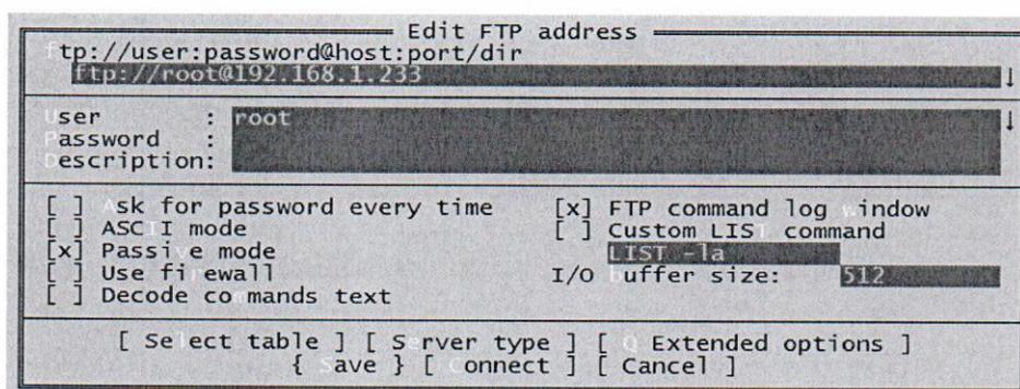
Рисунок 2 – Создание подключения к блоку БКД-ПК-RF.1
