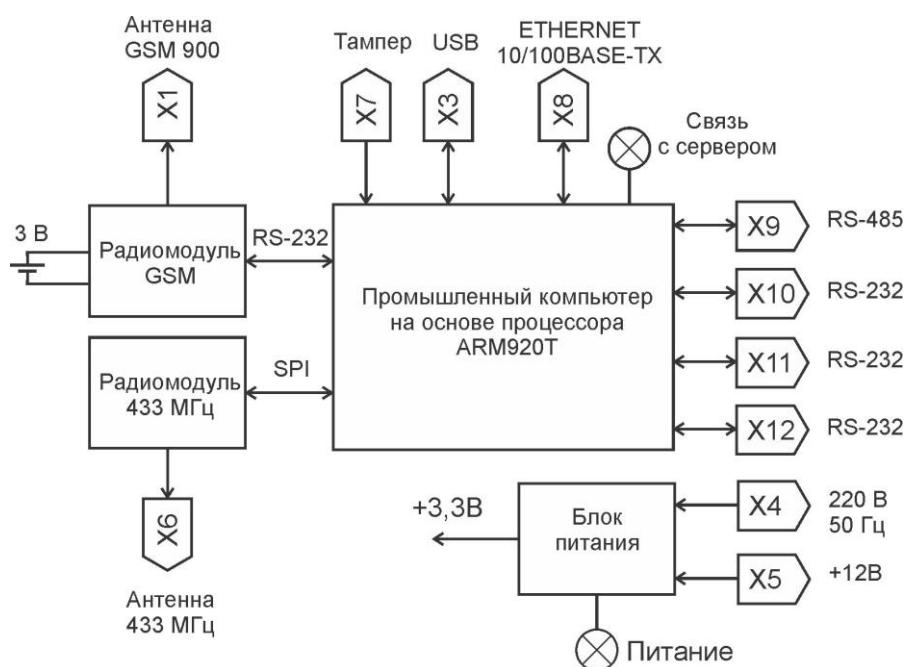
Промышленный компьютер состоит из следующих функциональных частей:
