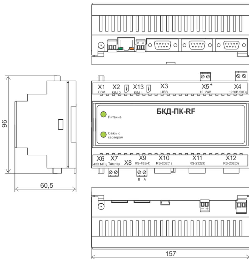
К разъемам X4, X5, X7, X9 подключаются внешние разъемы с клеммниками «под винт». Разъем X1 тип SMA (розетка) предназначен для подключения внешней антенны GSM 900/1800 МГц с волновым сопротивлением 50 Ом.
