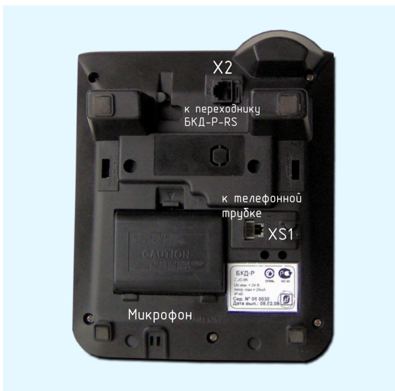
Рисунок 8 - Вид на разъемы БКД-Р
