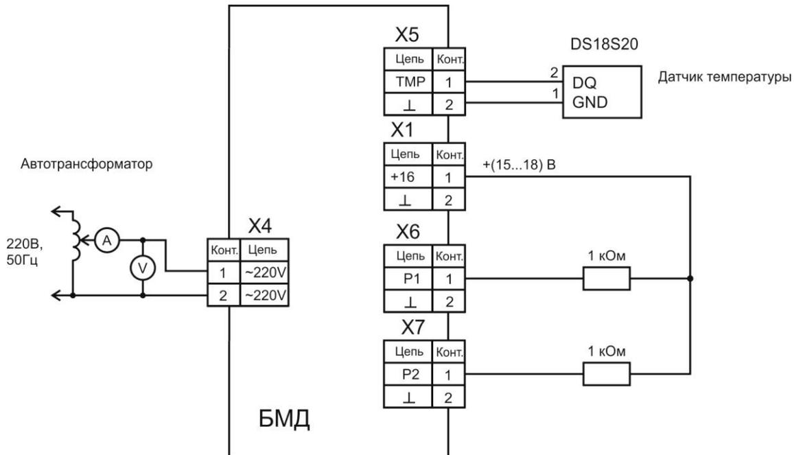
При помощи автотрансформатора, например, АОСН-2С, установить напряжение питания блока  $220\text{ В} \pm 5\%$ , контролируя значение напряжения по вольтметру переменного тока кл.2,5 на его выходе.
