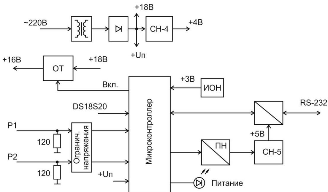
Электропитание БМД осуществляется от сети переменного тока 220 В, 50 Гц. Сетевое напряжение поступает на узел питания, состоящий из силового трансформатора, диодного выпрямителя, емкостного фильтра и импульсного стабилизатора напряжения СН-4, который формирует напряжение +4 В. Узел питания формирует постоянное напряжение 18 В для питания каналов измерения тока P1, P2.
