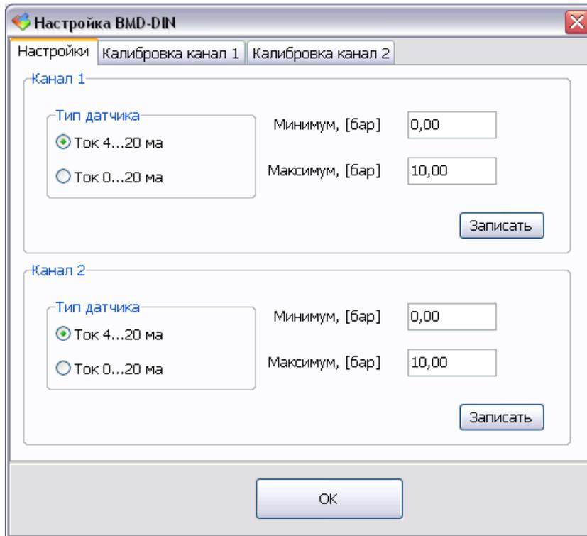
Открыть вкладку «Калибровка канал 1». На вход измерительного канала P1 (разъем X6) проверяемого БМД вместо первичного преобразователя, соблюдая полярность, подать постоянный электрический ток 0,000 мА от калибратора тока или отсоединить все цепи от разъема X6. Нажать на кнопку «Калибровка 0». Справа в окне появится код смещения нуля.
