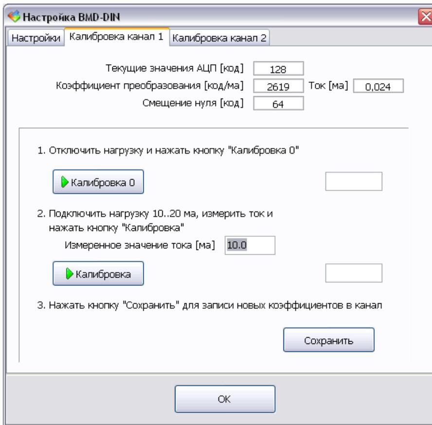
Затем подать постоянный электрический ток 20,000 мА от калибратора тока. Ввести в поле «Измеренное значение тока» значение тока по показаниям калибратора тока в мА. Нажать на кнопку «Калибровка». Справа в окне появится код коэффициента преобразования.
