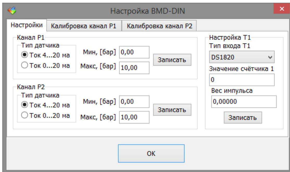
Открыть вкладку «Калибровка канал 1». На вход измерительного канала P1 (разъем X6) проверяемого БМД вместо первичного преобразователя, соблюдая полярность, подать
