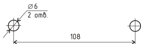
Рисунок 22 - Шаблон для сверления отверстий крепления
