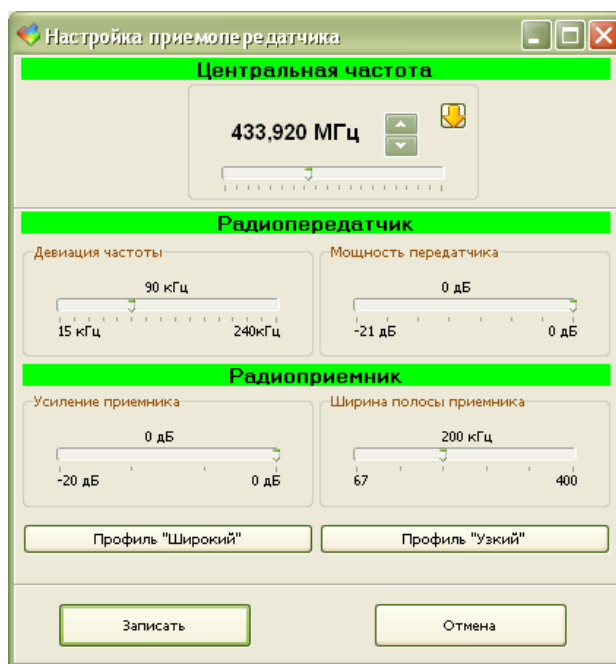
Рисунок 37 - Настройка приемопередатчика радиоканала
