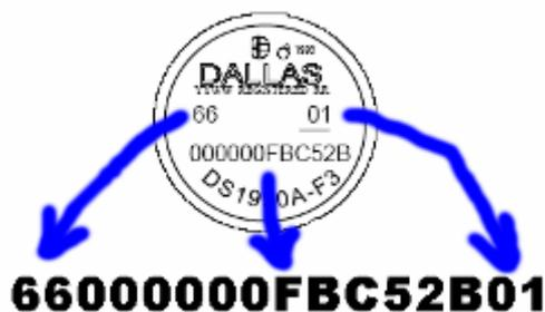
Рисунок 26 – Считывание кода ключа с корпуса
