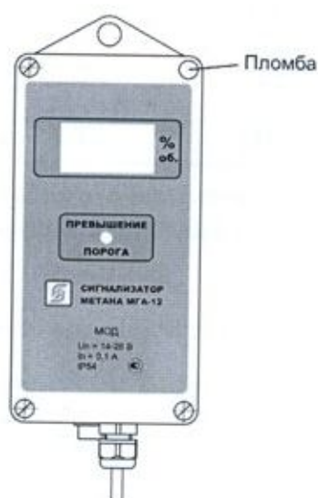
Рисунок 2 - Схема пломбировки МОД
