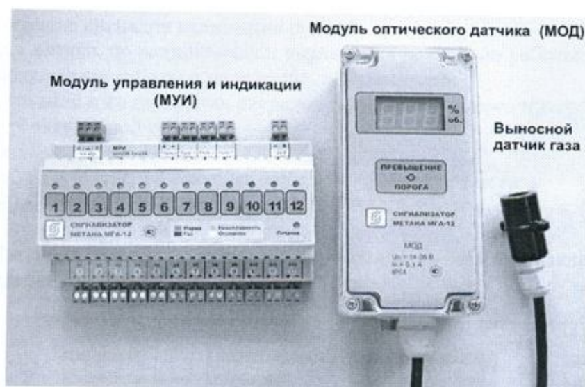
Рисунок 1 - Общий вид сигнализатора метана МГА-12
