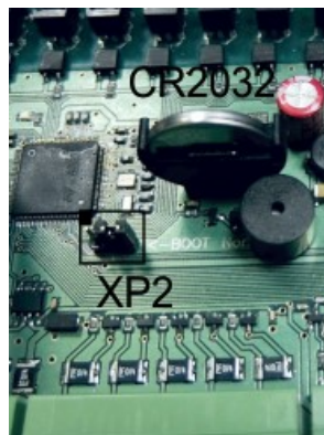
Рисунок 32 – Встроенный элемент питания модуля
