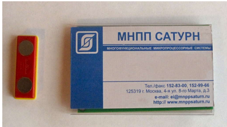
Рисунок 1 - Фотография радиометки в виде носимого бейджика
