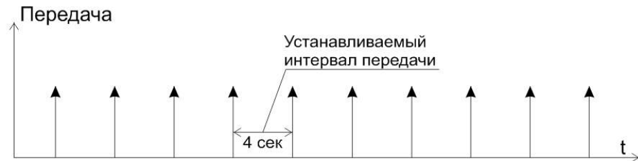
Рисунок 4 - Режим ПЕРЕДАТЧИК радиометки
