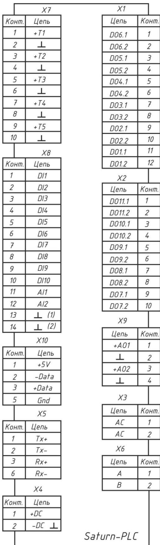
*X1, X2 – Выходы электронных реле 0,13 А при 220 В, (11 каналов) для подключения насосов, клапанов, нагревателей и проч. через магнитные пускатели*
