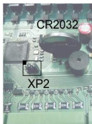
Рисунок 5 – Встроенный элемент питания контроллера «Saturn-PLC»
