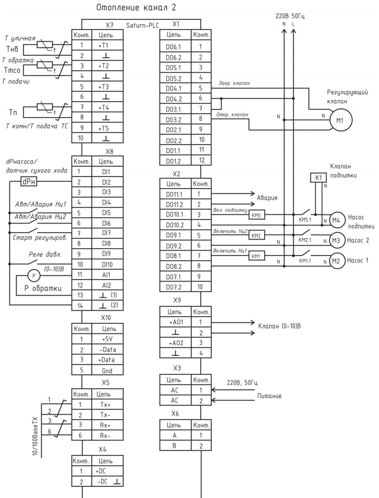
*Таблица 3- Подключение внешних цепей и назначение сигналов в режимах «Отопление» для канала №2*
