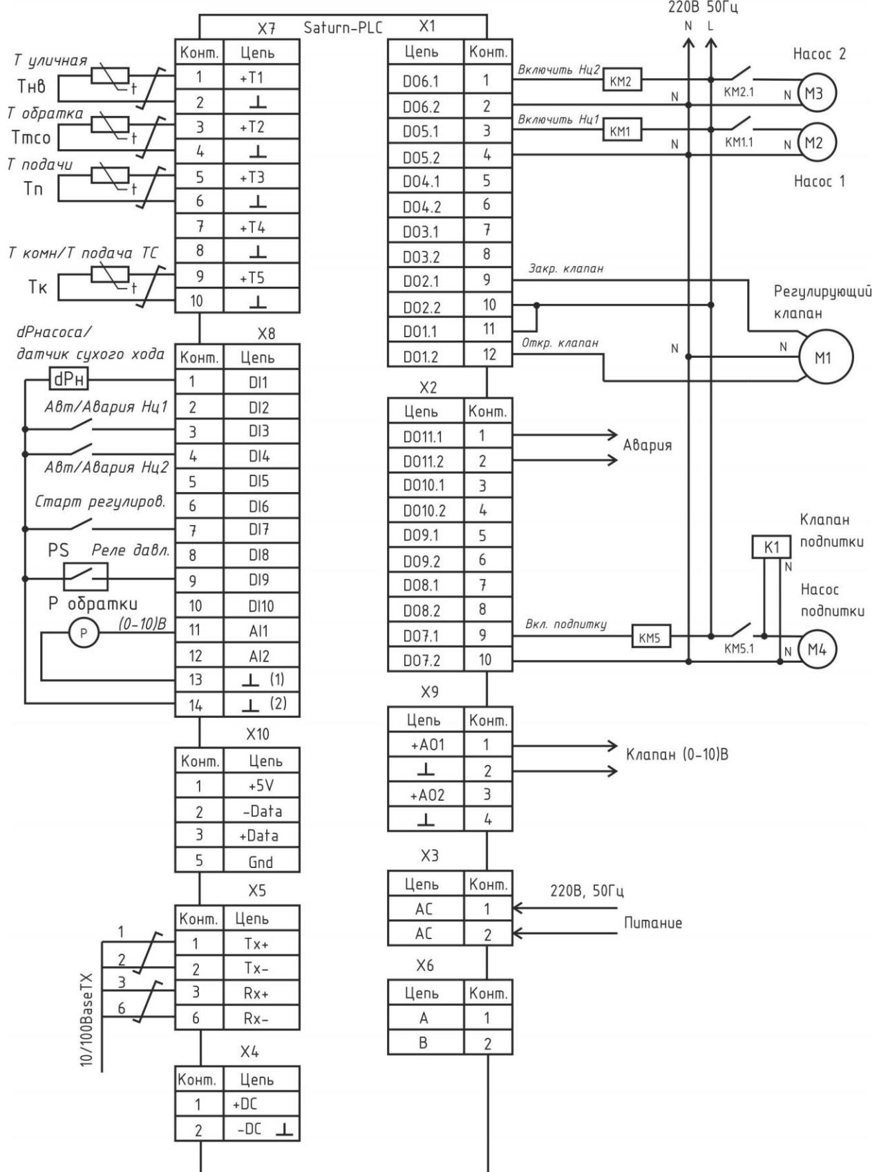
Схема подключения датчиков и исполнительных механизмов, интерфейсов к контроллеру в режиме «Отопление» для канала №1 (схема 5) с двумя насосами подпитки показана на рисунке ниже.
