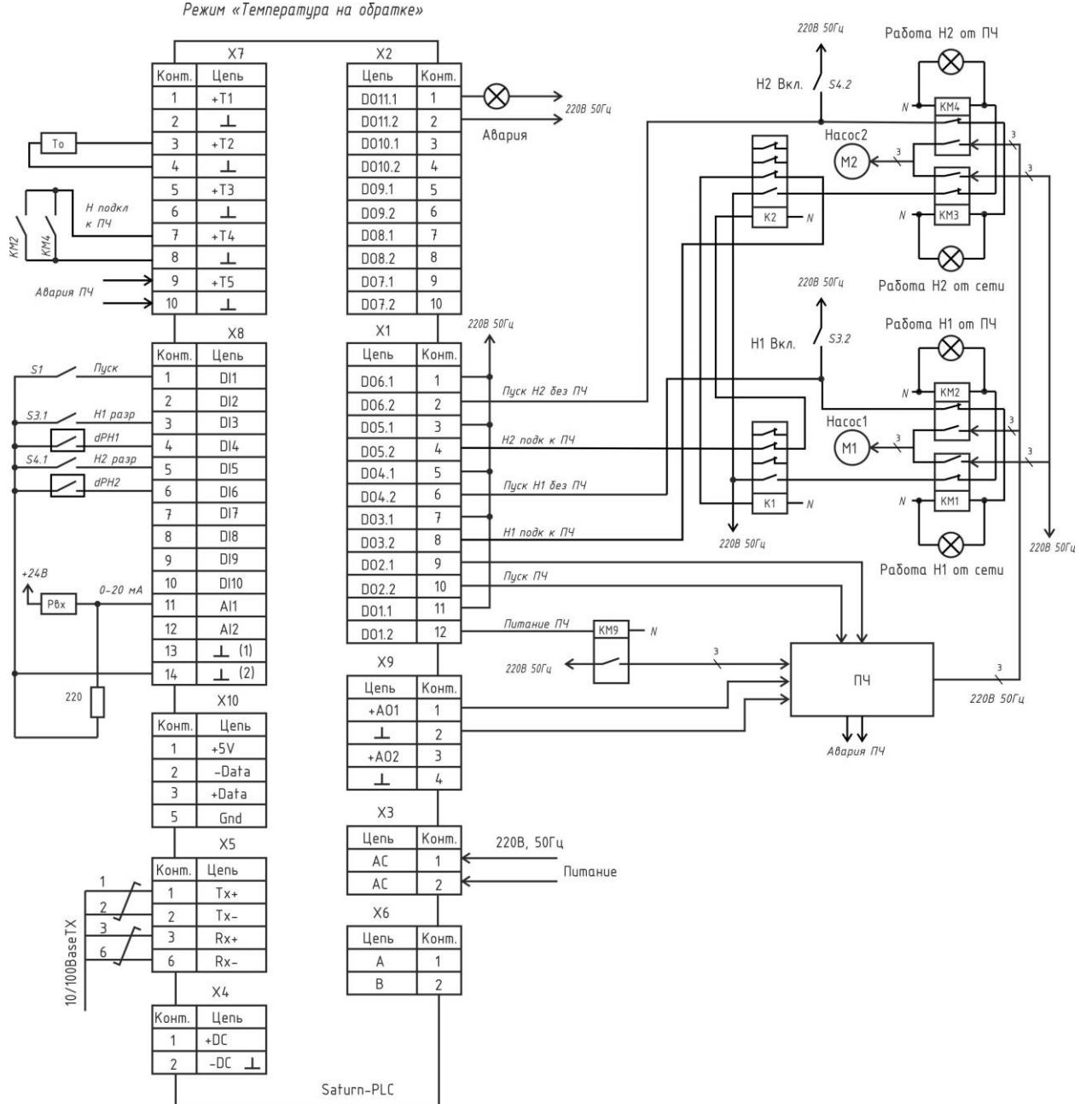
Датчик температуры To в обратной трубе подключается к входу T2 контроллера. Насосы 1 и 2 питаются от одного преобразователя частоты ПЧ. Реле K1, K2 служат для исключения одновременного подключения к ПЧ двух насосов. Контакторы КМ1, КМ3 подключают насосы к сети питания напрямую. КМ2, КМ4 подключают насосы к выходу ПЧ. Переключатели S3 и S4 служат для перевода насосов Н1 и Н2 в режим автоматического управления, отключения и принудительного включения. КМ9 подает напряжения питания на ПЧ.
