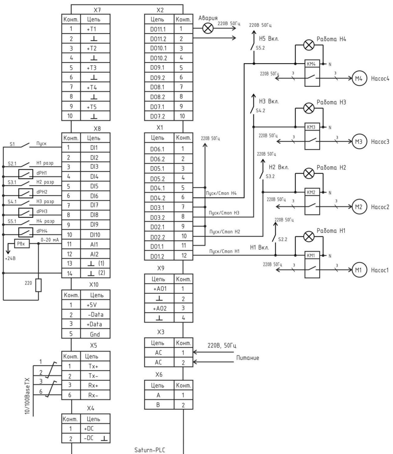
Контакторы КМ1, КМ3, КМ3, КМ4 подключают насосы к сети питания напрямую. Переключатели S2, S3, S4 и S5 служат для перевода насосов Н1, Н2, Н3 и Н4 в режим автоматического управления, отключения и принудительного включения.
