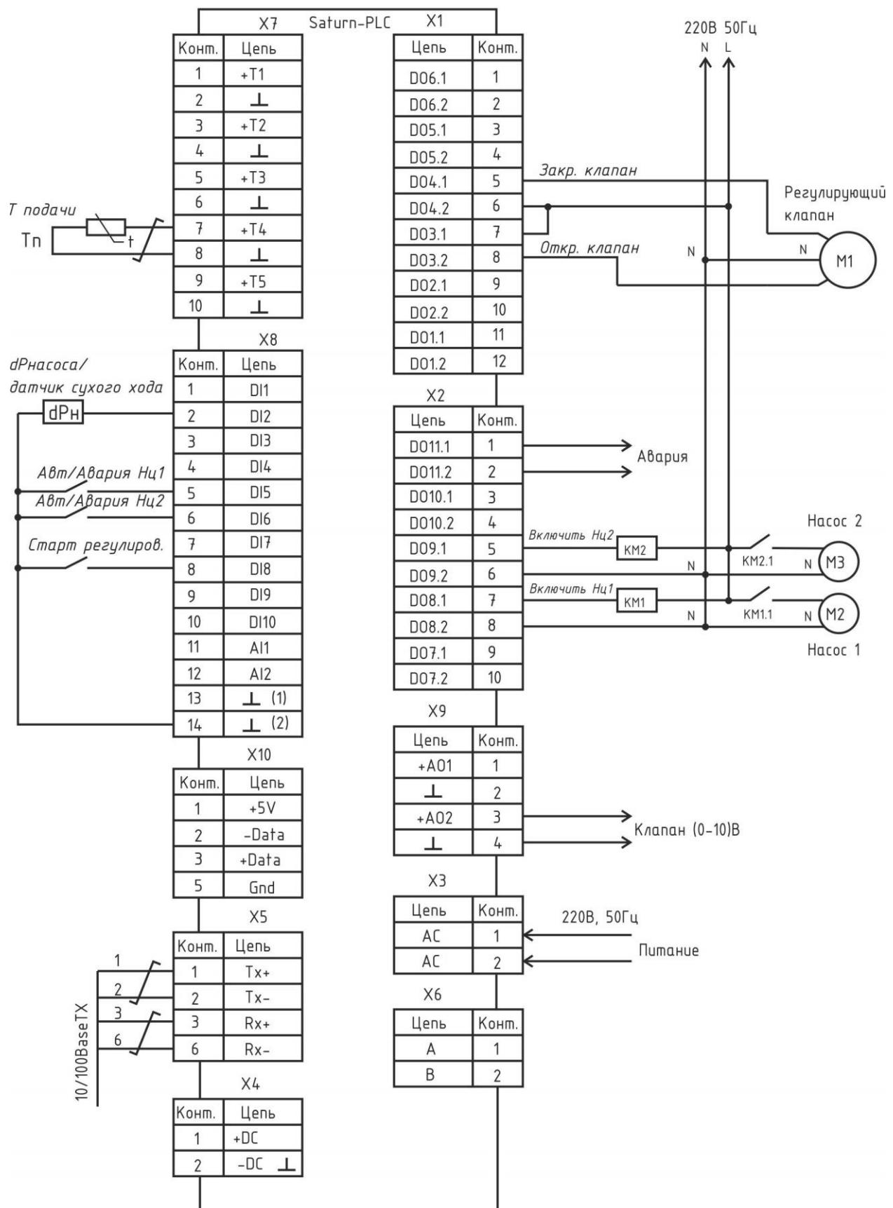
Схема подключения датчиков и исполнительных механизмов к контроллеру в режиме «ГВС» для канала №2 с одним циркуляционным насосом показана на рисунке ниже.
