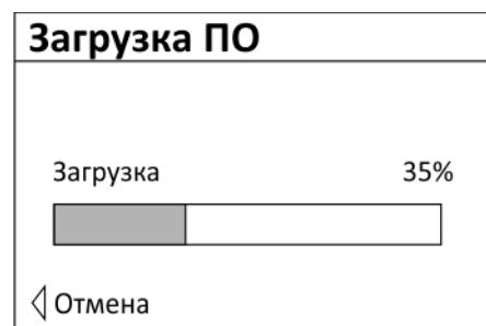
В конце произойдет перезагрузка контроллера и запустится режим работы в соответствии с загруженным ПО.
