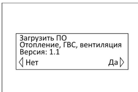
Начнется процесс загрузки нового ПО контроллера с сервера разработчика МНПП «Сатурн» по сети Ethernet. Загрузка ПО происходит в автоматическом режиме. Вначале будет очищена память контроллера и будет загружено новое ПО.
