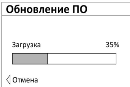
После завершения процедуры обновления контроллер автоматически перезагрузится.
