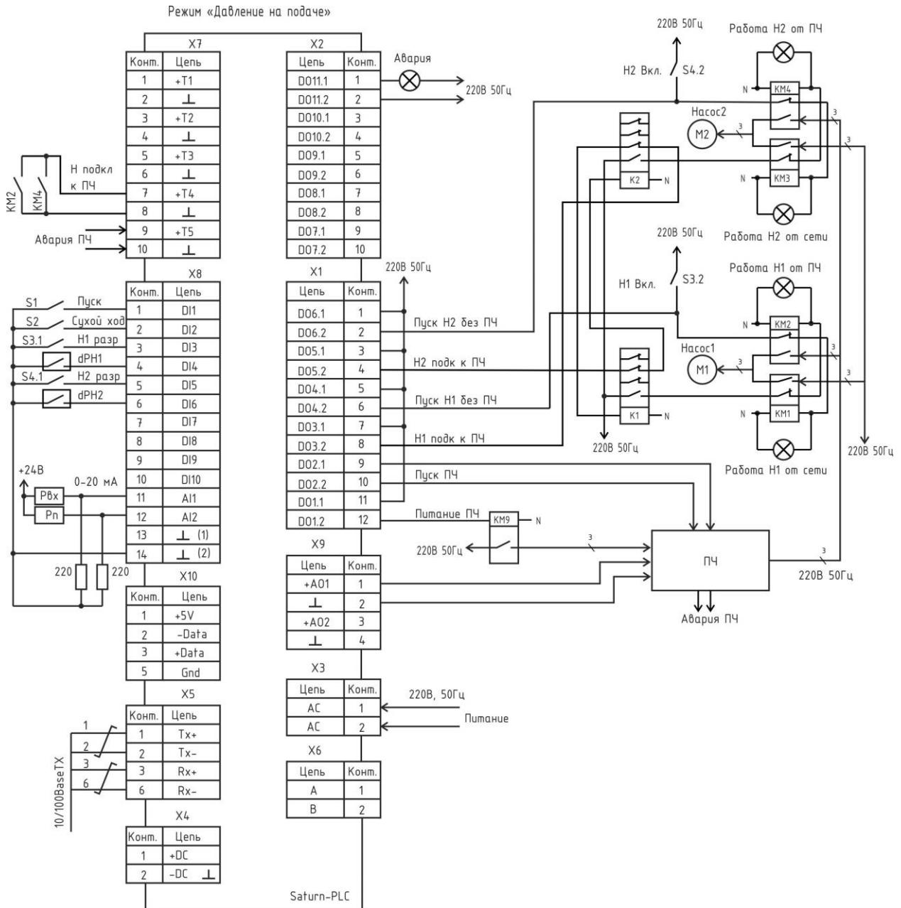
Насосы 1 и 2 питаются от одного преобразователя частоты ПЧ. Реле К1, К2 служат для исключения одновременного подключения к ПЧ двух насосов. Контакторы КМ1, КМ3 подключают насосы к сети питания напрямую. КМ2, КМ4 подключают насосы к выходу ПЧ. Переключатели S3 и S4 служат для перевода насоса Н1 и Н2 в режим автоматического управления, отключения и принудительного включения. КМ9 подает напряжения питания на ПЧ.
