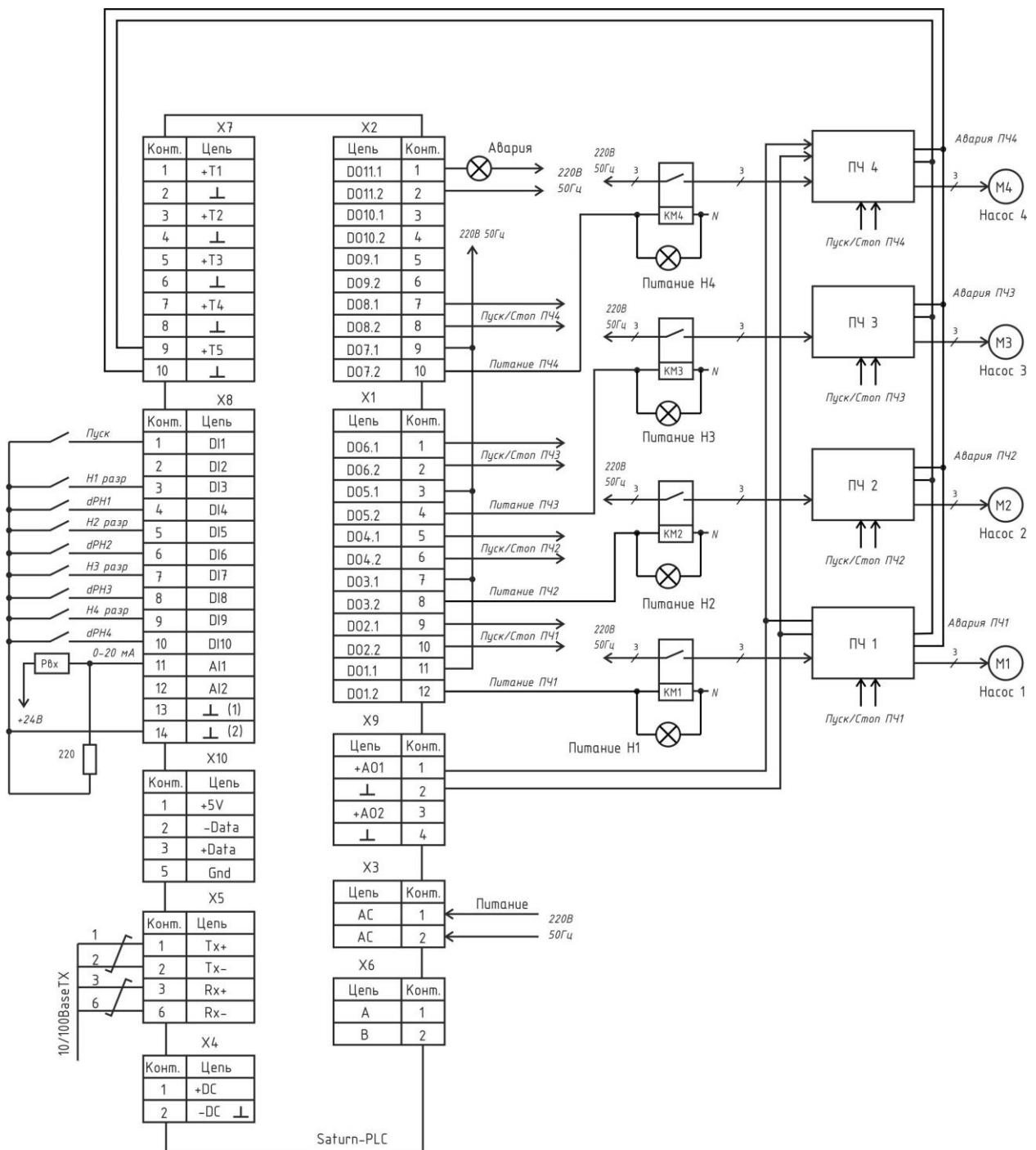
Контакторы КМ1, КМ3, КМ3, КМ4 подключают преобразователи частоты ПЧ1, ПЧ2, ПЧ3, ПЧ4 насосов Н1, Н2, Н3, Н4 к сети питания.
