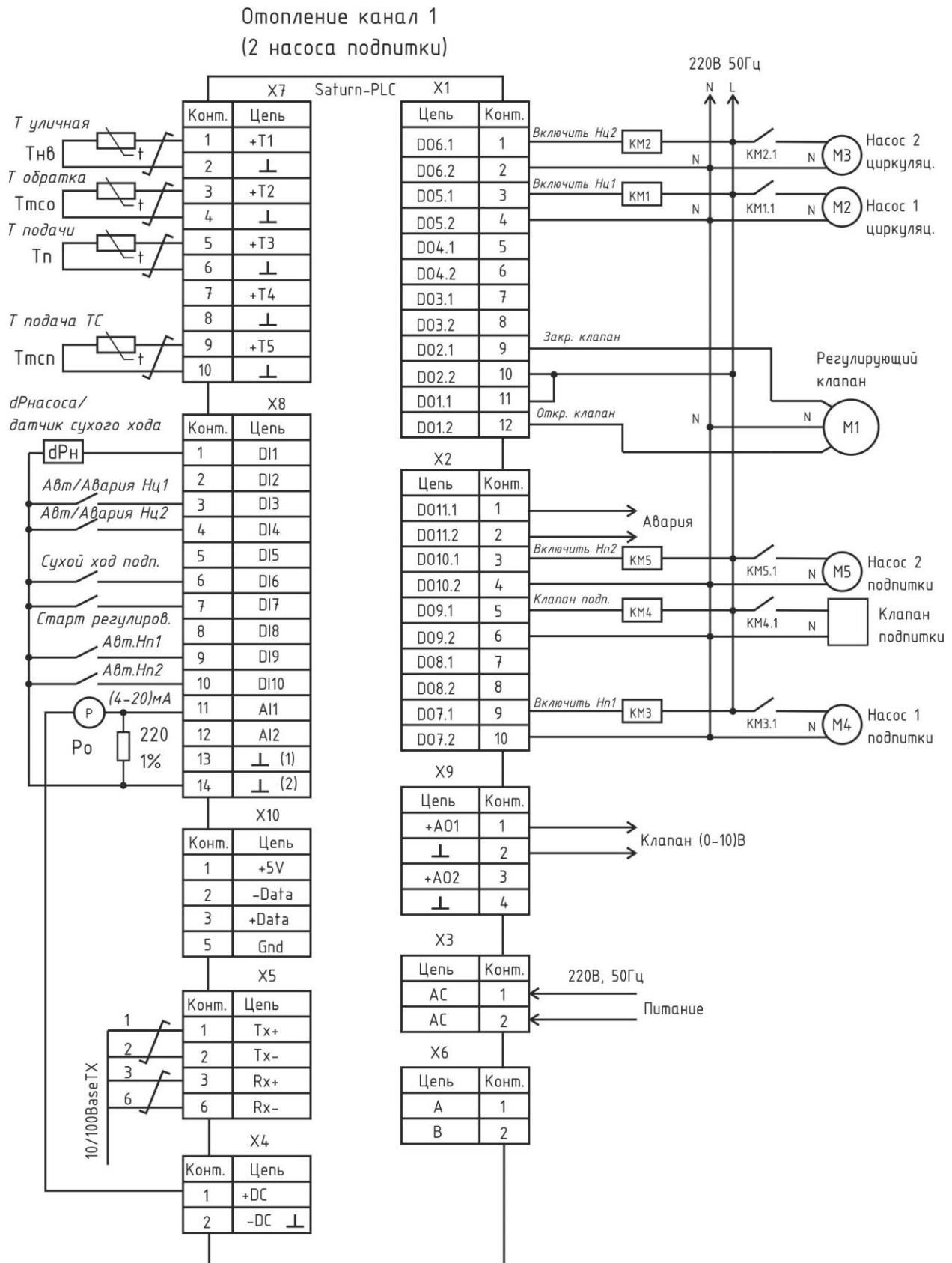
*Таблица 2 - Подключение внешних цепей и назначение сигналов в режимах «Отопление» для канала №1.*
