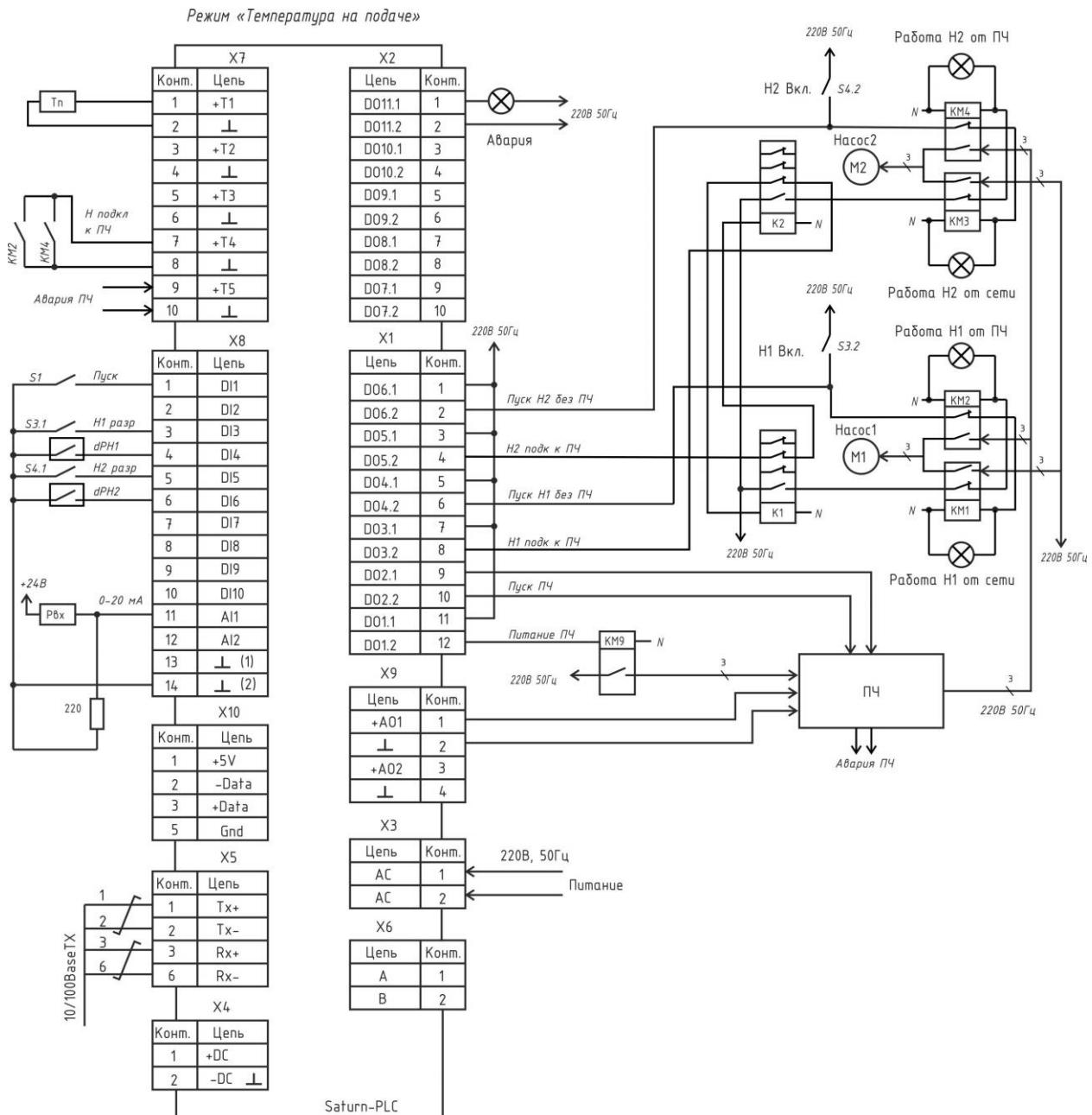
Датчик температуры Тп в подающей трубе подключается к входу T1 контроллера. Насосы 1 и 2 питаются от одного преобразователя частоты ПЧ. Реле K1, K2 служат для исключения одновременного подключения к ПЧ двух насосов. Контакторы KM1, KM3 подключают насосы к сети питания напрямую. KM2, KM4, KM6 подключают насосы к выходу ПЧ. Переключатели S3, S4, S5 служат для перевода насосов H1, H2, H3 в режим автоматического управления, отключения и принудительного включения. KM9 подает напряжения питания на ПЧ.
