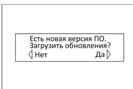
Если на сервере разработчика МНПП «Сатурн» имеется новая версия ПО контроллера, то, после подтверждения действия пользователем «Да→», произойдет автоматическая запись программы в память контроллера. Это займет несколько секунд.
