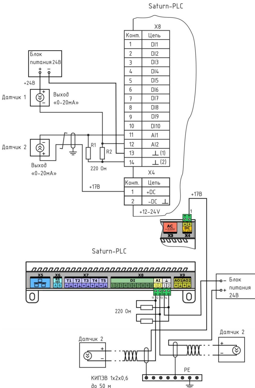
15. Для питания датчика может использоваться внешний источник напряжения с выходом постоянного стабилизированного напряжения +24В и током 0,1 А.
