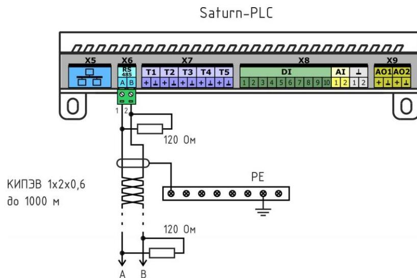
20. Подключить к разъему X5 типовой соединитель локальной сети 100Base-TX до щелчка с разъемами 8Р8С для соединения с оборудованием сети Ethernet (маршрутизатор).
