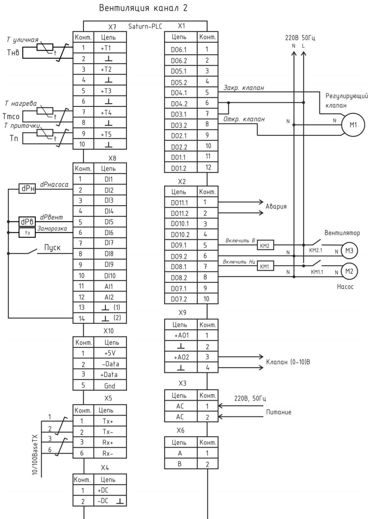
*Таблица 5 - Подключение внешних цепей и назначение сигналов в режиме «Вентиляция» для каналов № 1 и № 2*
