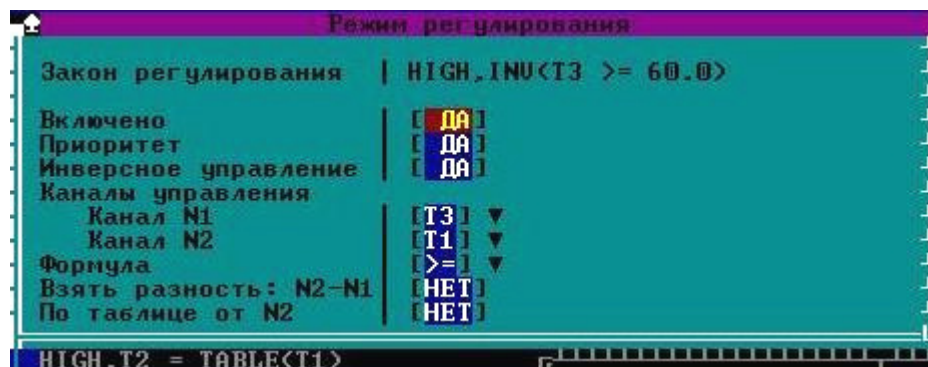
Рисунок 26 - Закон поддержания температуры котельной
