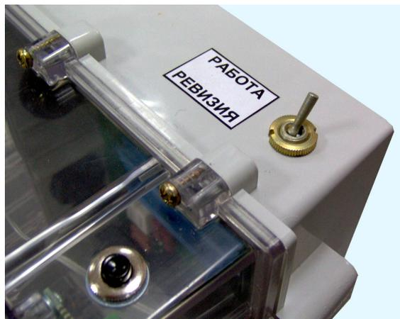
Рисунок 12 - Тумблер блокировки УБ в положении «Ревизия»
