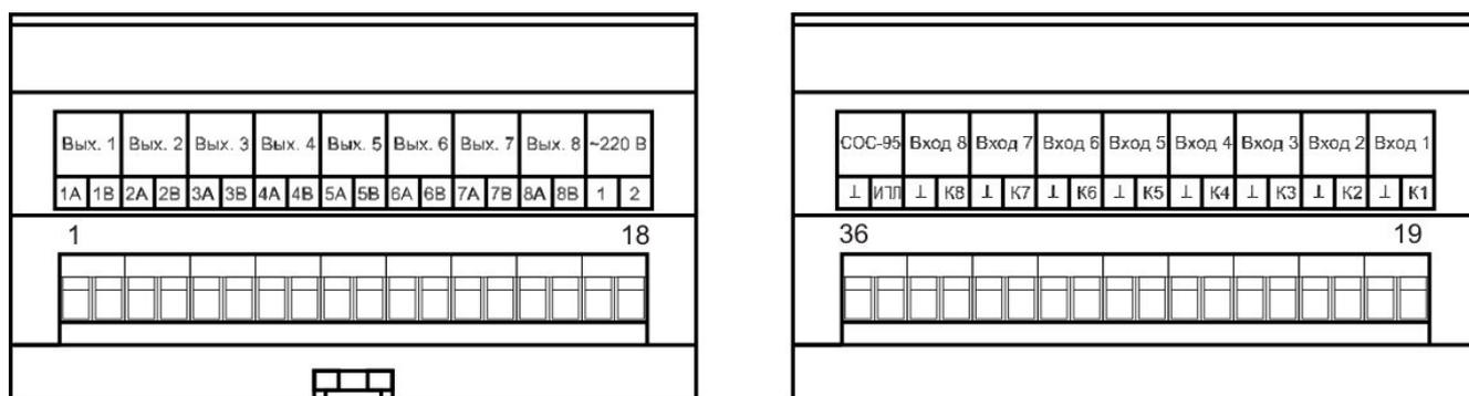
Рисунок 4 - Маркировка контактов разъемов БИУ-DIN
