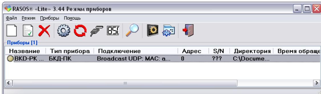
Нажать на кнопку «Тестирование прибора F6». Откроется окно с настроочными параметрами сетевых интерфейсов. Для доступа к настройкам должен быть введены правильные имя и пароль пользователя.
