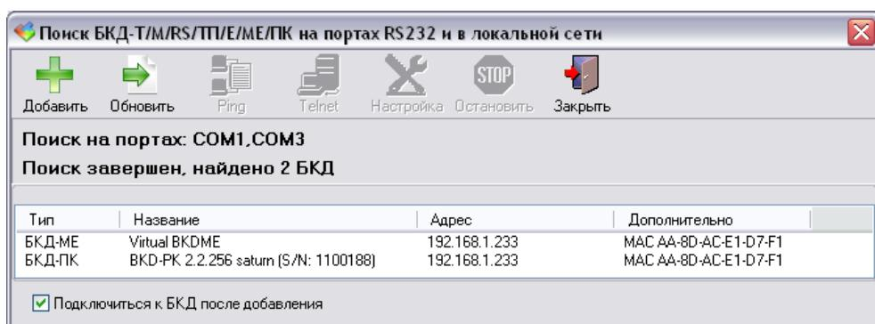
Выбрать БКД-ПК и нажать на кнопку «Добавить». БКД-ПК будет добавлен в таблицу устройств.
