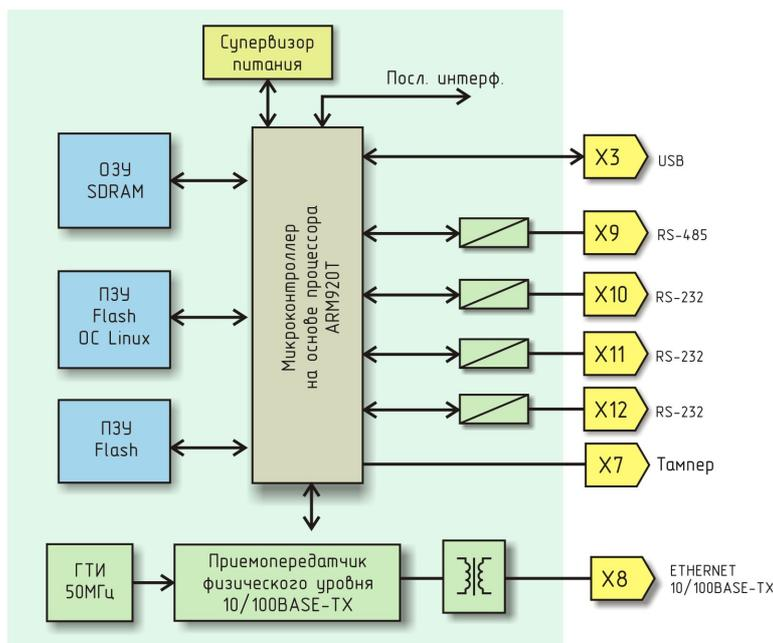
Рисунок 6 - Структурная схема промышленного компьютера
