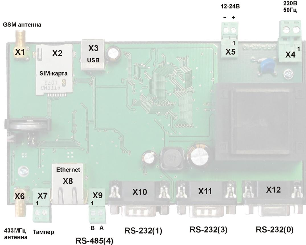
Рисунок 3 - Вид на плату БКД-ПК-RF (крышка снята)
