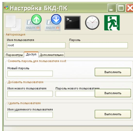
Рисунок 12 - Окно настройки параметров доступа к БКД-ПК-RF
