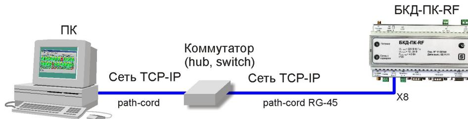
Рисунок 8 - Схема подключения БКД-ПК-RF к ПК
