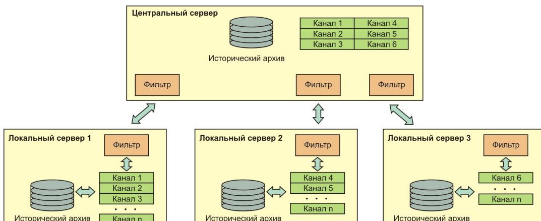
Рисунок 16 - Каскадирование серверов
