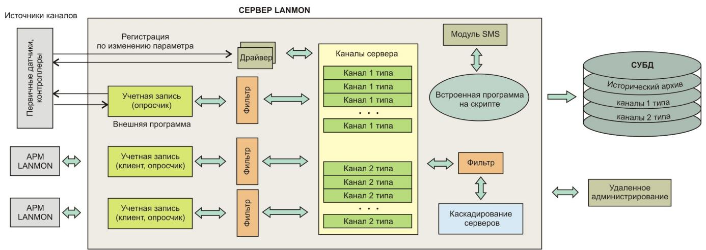
Рисунок 1 - Структурная схема сервера LanMon
