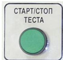
Индикатор стенда начинает быстро мигать, отображая процесс тестирования. Цвет индикатора - зелёно-жёлтый или красно-жёлтый означает об успешном или неуспешном процессе тестирования.
