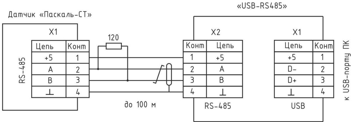
Схема подключения датчика «Паскаль-СТ» к компьютеру оператора
