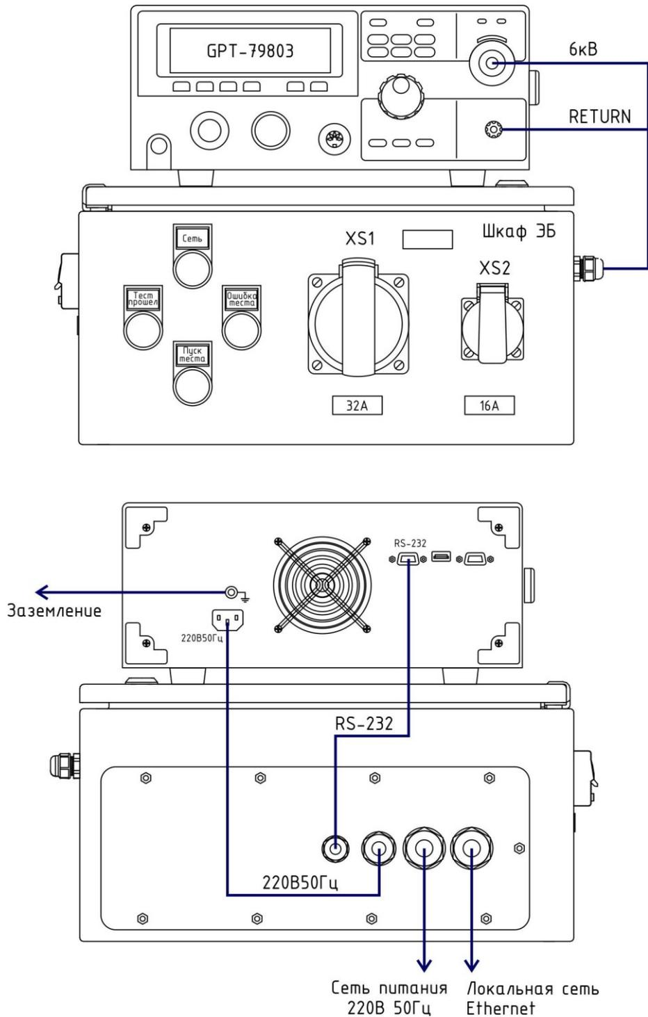
Рисунок 4 – Подключение кабелей шкафа СЭБ
