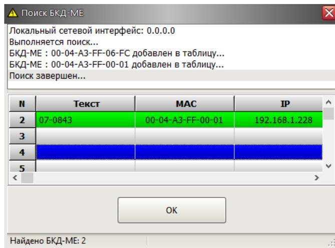
Откроется окно с настроечными параметрами блока БКД-МЕ, где следует установить требуемые сетевые параметры шкафа ЭБ (IP адрес, маску подсети, IP адрес основного шлюза) и нажать «ОК» для записи настроек в блок БКД-МЕ.
