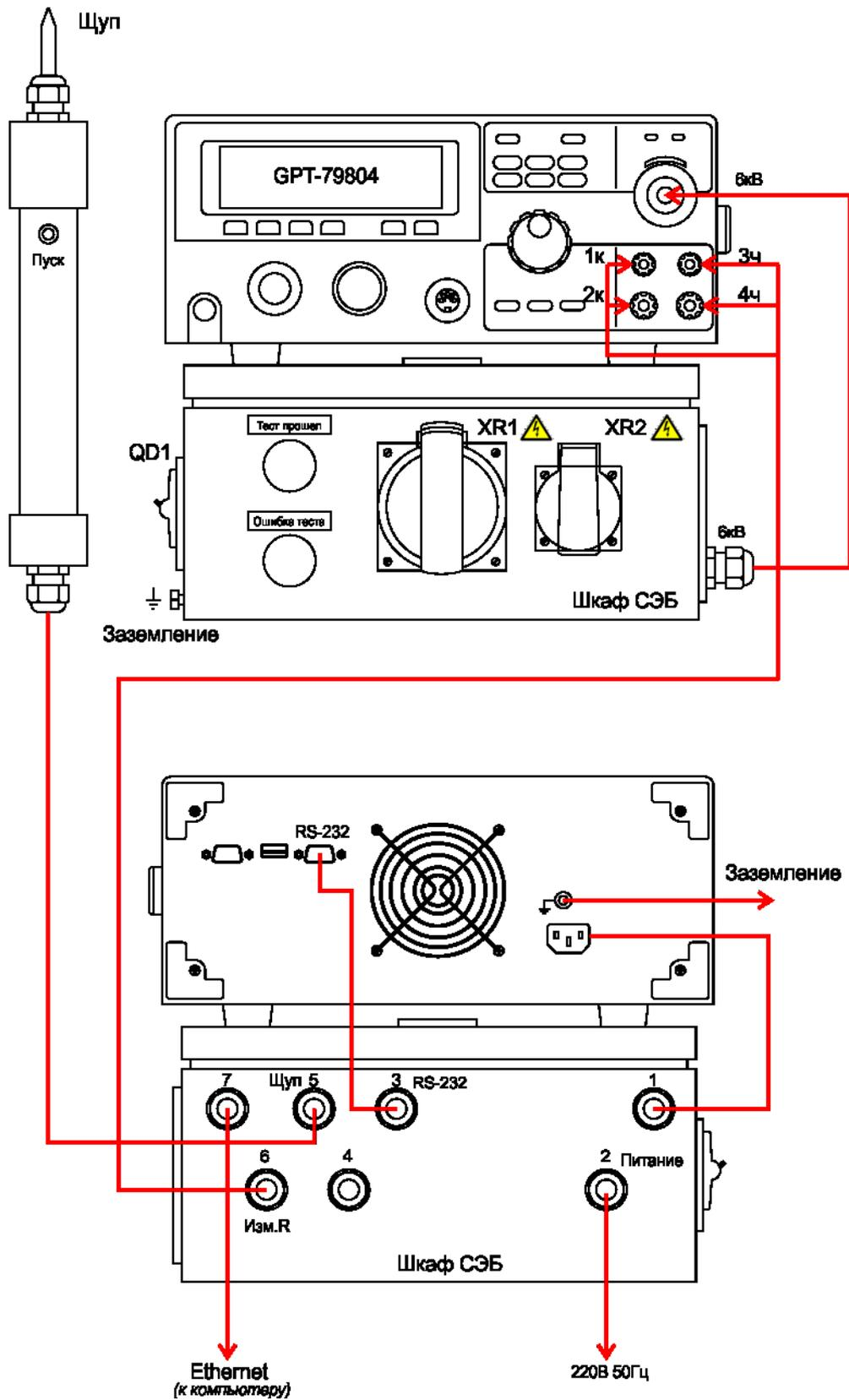
Рисунок 4 – Подключение кабелей стенда контроля параметров электробезопасности установок
