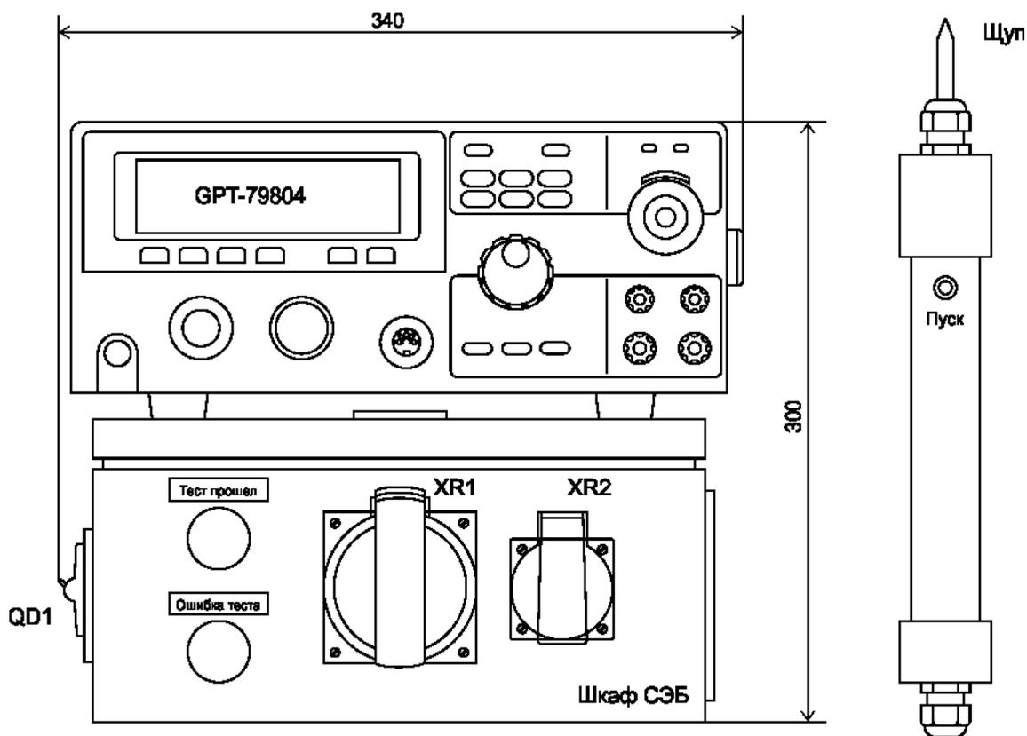
Рисунок 3 – Габаритные размеры стенда СЭБ
