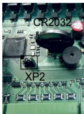
Рисунок 5 – Встроенный элемент питания контроллера «Saturn-PLC»
